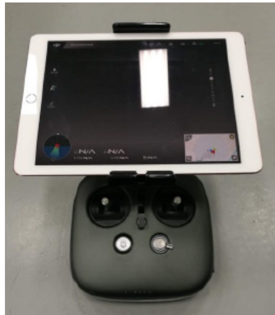
Remote ควบคุมแบบ Manual ที่ภาคพื้นดิน
