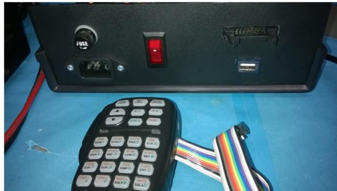
รูปที่ 3.13 กล่องชุดวงจรควบคุมภายนอกที่สามารถเชื่อมต่อรีโมตเครื่อง CB245 และ พอร์ต USB ได้
