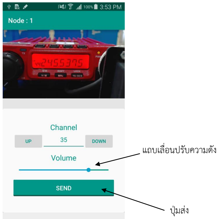
รูปที่ 4.36 การปรับระดับความดังและส่งข้อมูล
