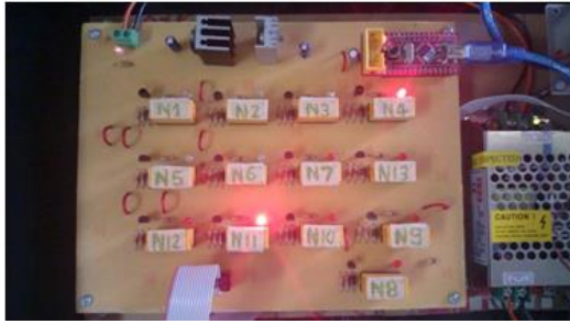
รูปที่ 4.6 แสดง Relay N4 และ N11 ถูกกระตุ้น
