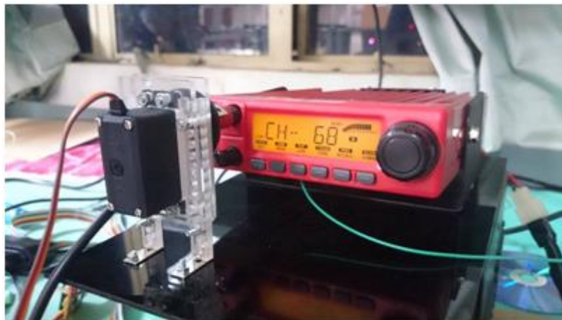
รูปที่ 3.16 แสดงการติดตั้ง Servo Motor ที่ปุ่มหมุนระดับเสียงและการยึดกับฐานชิ้นล่าง
