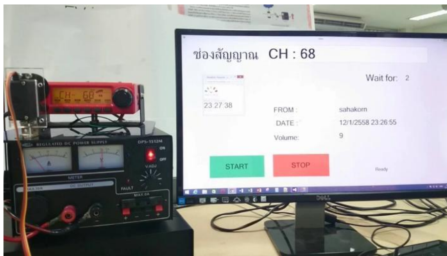
รูปที่ 4.10 ชุดควบคุมระบบอุปกรณ์ปลายทางเชื่อมต่อกับโปรแกรม Machine API ที่คอมพิวเตอร์
