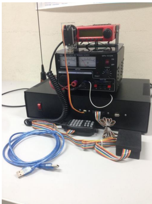
รูปที่ 4.1 ชุดอุปกรณ์ทดสอบ CB 245 ที่เชื่อมต่อกับชุดควบคุมระบบอุปกรณ์ปลายทาง
