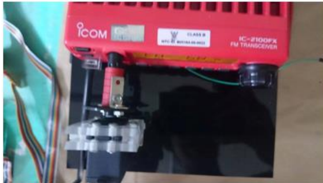
รูปที่ 3.14 แสดงโปรแกรมทดสอบระดับเสียง รูปที่ 3.15 แสดงการติดตั้ง Servo Motor ที่ปุ่มหมุนระดับเสียง
