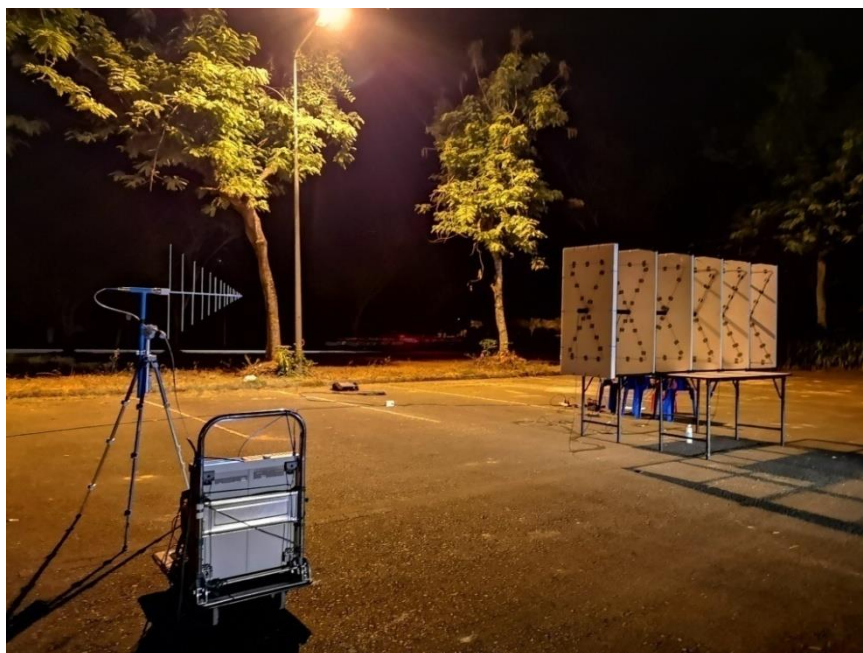
รูปที่ 4.97 โครงสร้างและการจัดตั้งระบบการวัดสายอากาศไดโพลรูปโบว์ที่สามารถปรับเปลี่ยนความถี่ได้ สำหรับกิจกรรมกระจายเสียง เอฟ.เอ็ม.
