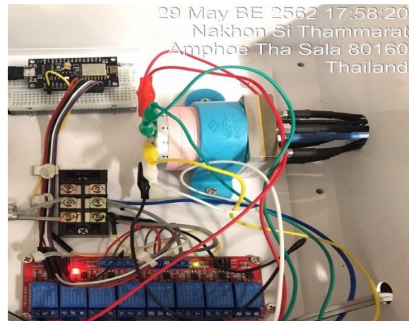
(ข) ระบบดำเนินการเชื่อมต่อกับสายอากาศ FM-5 ด้วยรีเลย์ชุดที่ 7
