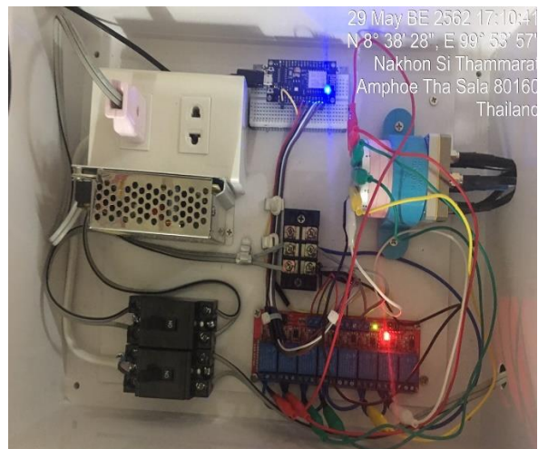
(ข) ระบบดำเนินการเชื่อมต่อกับสายอากาศ DTV-1 ด้วยรีเลย์ชุดที่ 2
