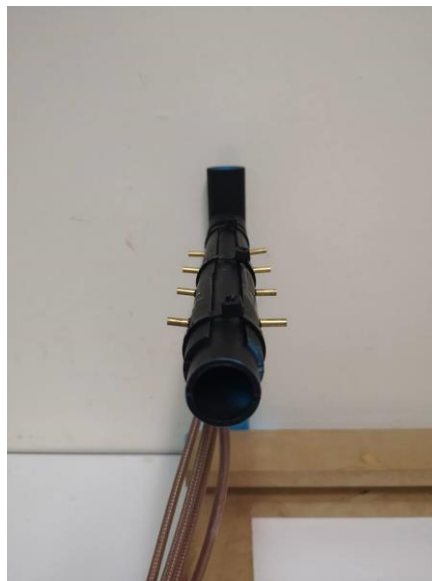
รูปที่ 4.113 โครงสร้างสายอากาศไดโพลที่สามารถปรับเปลี่ยนความถี่ได้ สำหรับกิจการโทรคมนาคม
