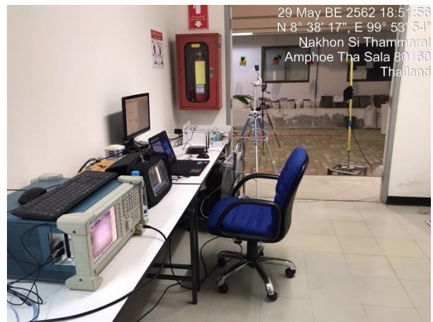
(จ) สายอากาศปรับเปลี่ยนความถี่กิจการกระจาย เสียง เอฟ.เอ็ม.ที่เชื่อมต่อกับระบบดำเนินการ
