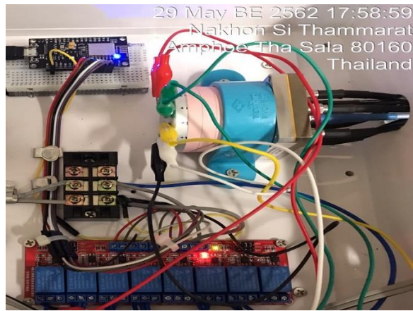
(ข) ระบบดำเนินการเชื่อมต่อกับสายอากาศ FM-2 ด้วยรีเลย์ชุดที่ 3
