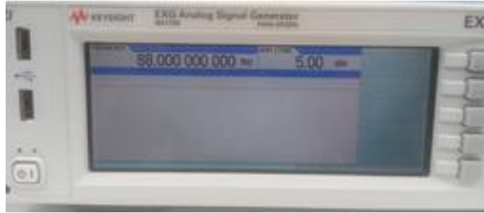
รูปที่ 5.72 ผลการควบคุมเครื่องกำเนิดสัญญาณ ในช่องสัญญาณ 88.00 MHz ด้วยระดับกำลังส่ง 5 dBm
