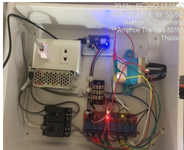
(ข) ระบบดำเนินการเชื่อมต่อกับสายอากาศ DTV-3 ด้วยรีเลย์ชุดที่ 5
