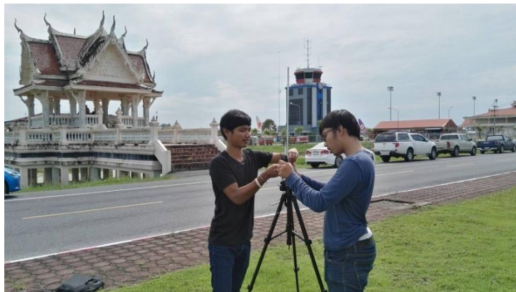
รูปที่ 3.19 การจัดตั้งสายอากาศรับสำหรับวัดกำลังคลื่นความถี่วิทยุ FM บริเวณสนามบินนครศรีธรรมราช
