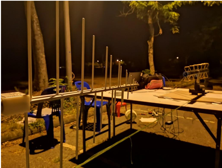
รูปที่ 4.105 โครงสร้างและการจัดตั้งระบบการวัดสายอากาศไดโพลรูปโบว์ที่สามารถปรับเปลี่ยนความถี่ได้ สำหรับกิจกรรมโทรทัศน์ดิจิทัล
