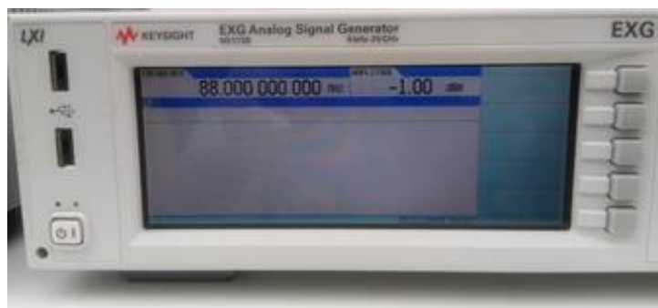
รูปที่ 5.67 ผลการควบคุมเครื่องกำเนิดสัญญาณ ในช่องสัญญาณ 88.00 MHz ด้วยระดับกำลังส่ง -1.0 dBm
