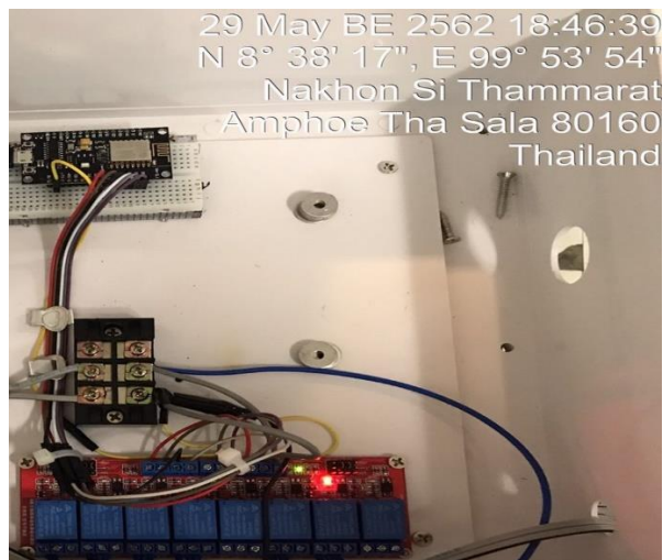
(ข) ระบบดำเนินการเชื่อมต่อกับสายอากาศ Mb-1 ด้วยรีเลย์ชุดที่ 2
