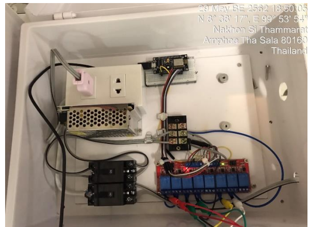
(ข) ระบบดำเนินการเชื่อมต่อกับสายอากาศ Mb-4 ด้วยรีเลย์ชุดที่ 6
