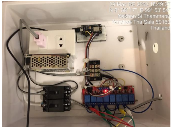
(ข) ระบบดำเนินการเชื่อมต่อกับสายอากาศ Mb-3 ด้วยรีเลย์ชุดที่ 5
