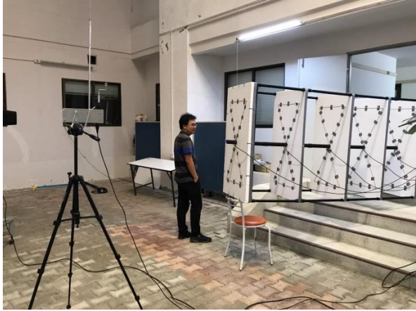
(ง) สายอากาศของระบบสังเกตการณ์และ สายอากาศกิจการกระจายเสียง เอฟ.เอ็ม.
