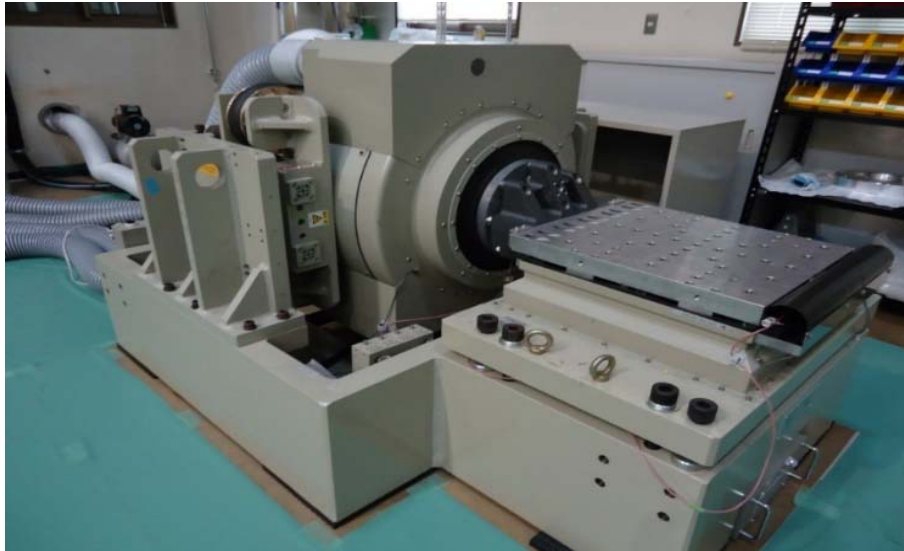
รูปที่ 13.2 ภาพถ่ายเครื่องทดสอบการสั่นสะเทือน
