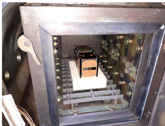
รูปที่ 15.33 ภาพถ่ายขณะที่ดาวเทียมอยู่ภายในเครื่อง Vacuum Brazing Furnace
