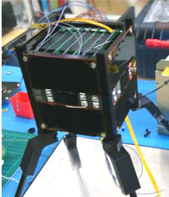
รูปที่ 14.5 ภาพถ่ายขณะดาวเทียมติดตั้งอยู่บนอุปกรณ์จับยกให้ลอยขึ้นมา
