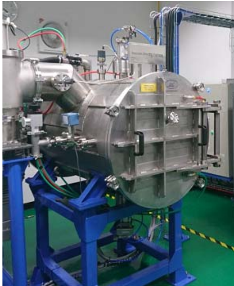
รูปที่ 15.32 ภาพถ่ายเครื่อง Vacuum Brazing Furnace
