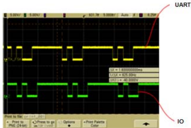
รูปที่ 5.7 ผลการวัดของข้อมูลที่ส่งออก (0x7E) ด้วยเครื่อง Oscilloscope
