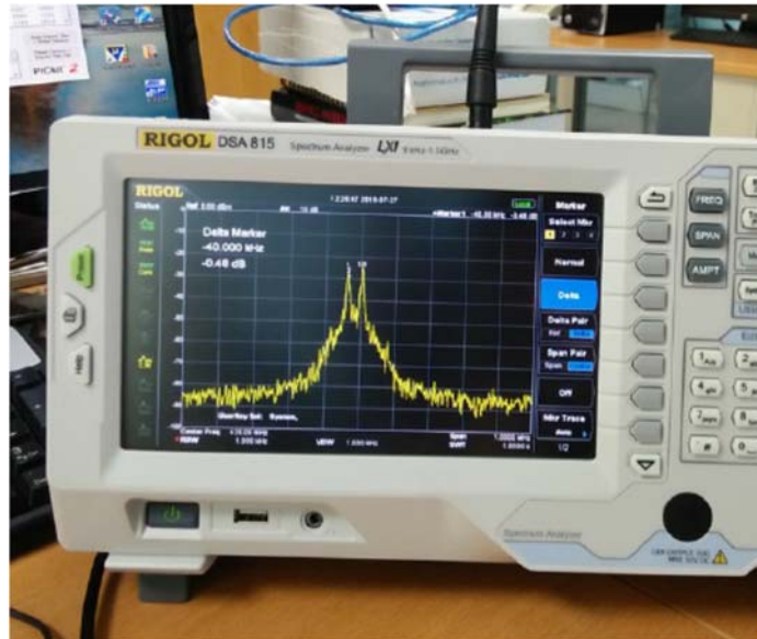
รูปที่ 10.8 การทดสอบส่งสัญญาณข้อมูลผ่านคลื่นวิทยุแบบ FSK (9600bps)
