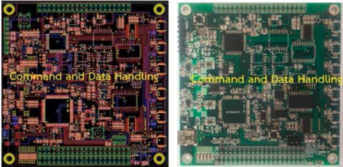
รูปที่ 10.10 (ซ้าย) ลายวงจร PCB ของระบบ CDH (ขวา) แผ่น PCB ของระบบ CDH
