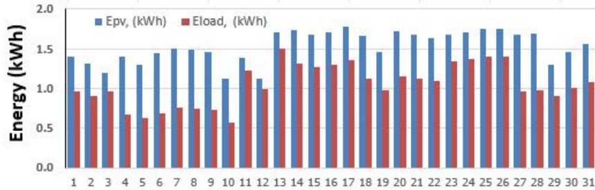
รูปที่ ๓๔ ปริมาณไฟฟ้าที่ผลิตได้จากระบบเซลล์แสงอาทิตย์และปริมาณการใช้ไฟฟ้าในเดือนมกราคม ๒๕๖๐ ณ โบสถ์คริสต์จักรบ้านตะโตะโก
