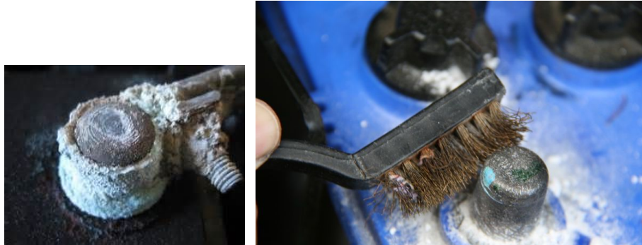
รูปที่ ๗ คราบที่เกิดจากการกัดกร่อนที่ขั้วแบตเตอรี่ และการทำความสะอาด
