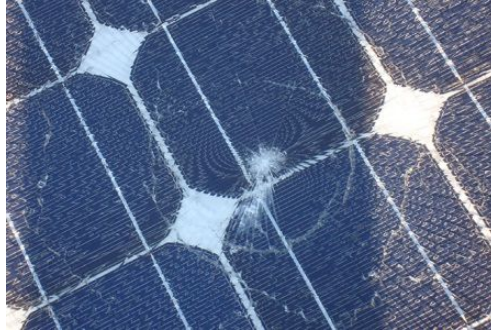
รูปที่ ๕ การแตกร้าวของแผงพลังงานแสงอาทิตย์
