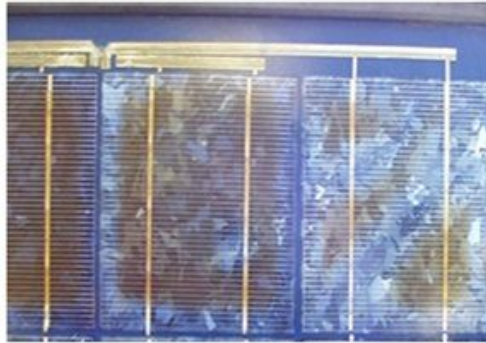
รูปที่ ๘ การเปลี่ยนสีของแผงพลังงานแสงอาทิตย์ที่อาจเกิดจากความร้อน
