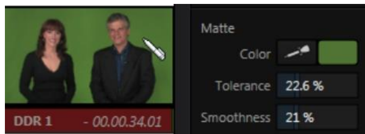
รูปที่ 45 การใช้ Color picker เพื่อเลือกสีฉากหลังจากภาพโดยตรง ของโปรแกรมควบคุม Newtek TriCaster 8000
