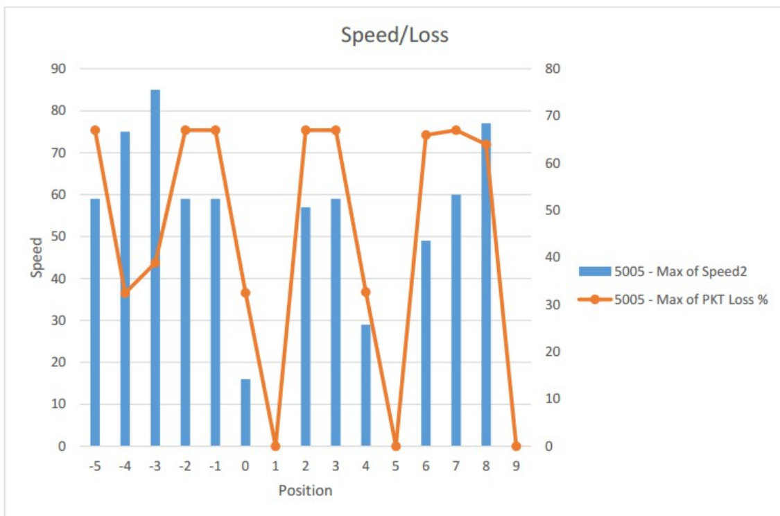
รูปที่ 3-7 แสดงความสัมพันธ์ระหว่างความเร็วในการเคลื่อนที่และค่าการสูญเสียข้อมูล
