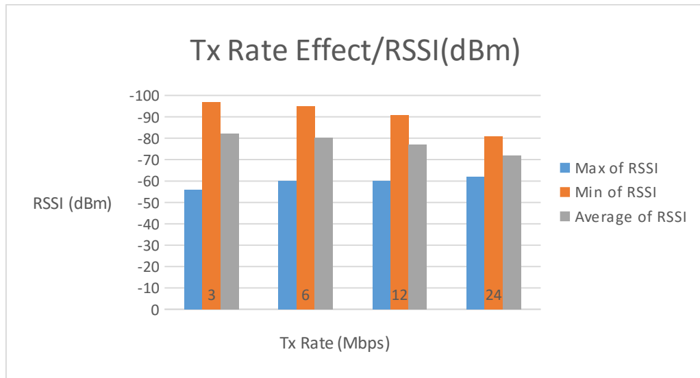
รูปที่ 3-12 แสดงค่า RSSI ที่ค่า Transmission Rate ต่างๆ
