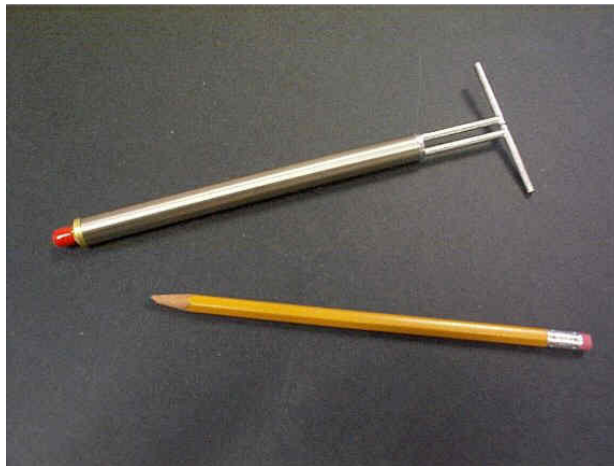
รูปที่ 4-27 โครงสร้างสายอากาศไดโพลร่วมกับบาลันบาซูก้าสำหรับประยุกต์ใช้ความถี่ 900 MHz
