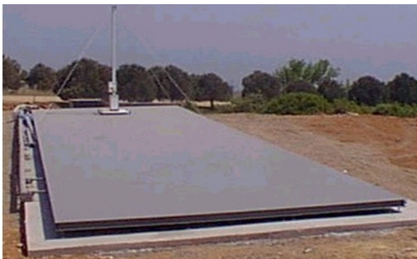
รูปที่ 2-1 แสดงการทดสอบหาระดับสัญญาณรบกวนแพร่กระจายผ่านอากาศบนพื้นที่เปิดโล่ง
