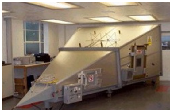
รูปที่ 2-4 แสดงการทดสอบหาระดับสัญญาณรบกวนแพร่กระจายผ่านอากาศโดยใช้ GTEM
