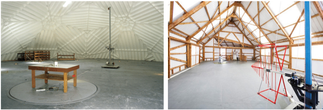
รูปที่ 2-14 โครงสร้างเพื่อปกป้องสถานะแวดล้อมขณะทดสอบขนาดใหญ่
