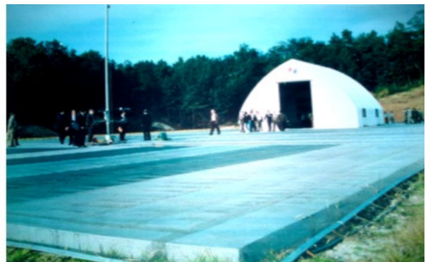
รูปที่ 2-1 แสดงการทดสอบหาระดับสัญญาณรบกวนแพร่กระจายผ่านอากาศบนพื้นที่เปิดโล่ง
