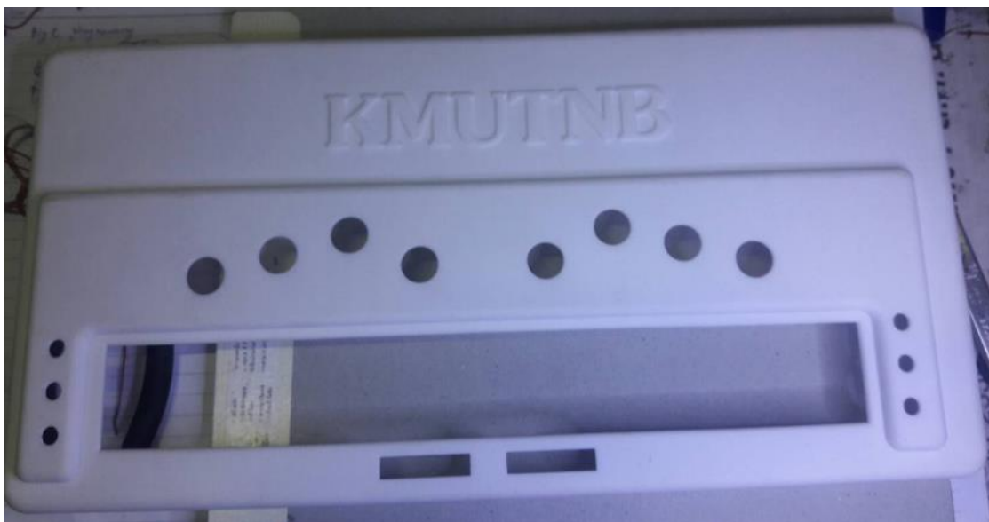
รูปที่ 3-24 ชุดฝาครอบสียบอร์ดที่ได้จากการพิมพ์สามมิติ
