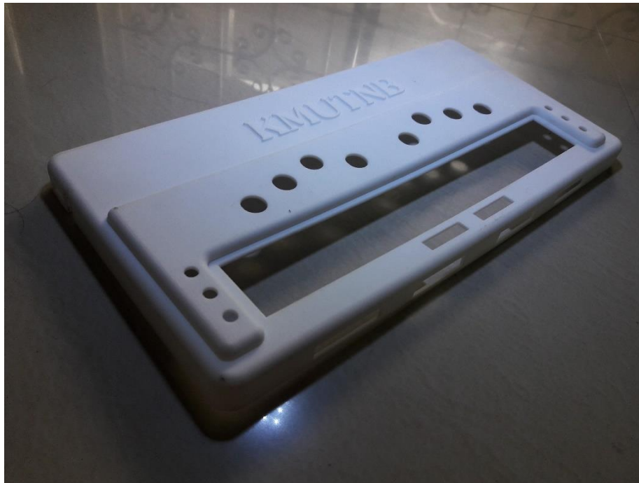
รูปที่ 6-1 เครื่องห่อหุ้ม Braille Display ที่ทำจากวัสดุ Polyimide
