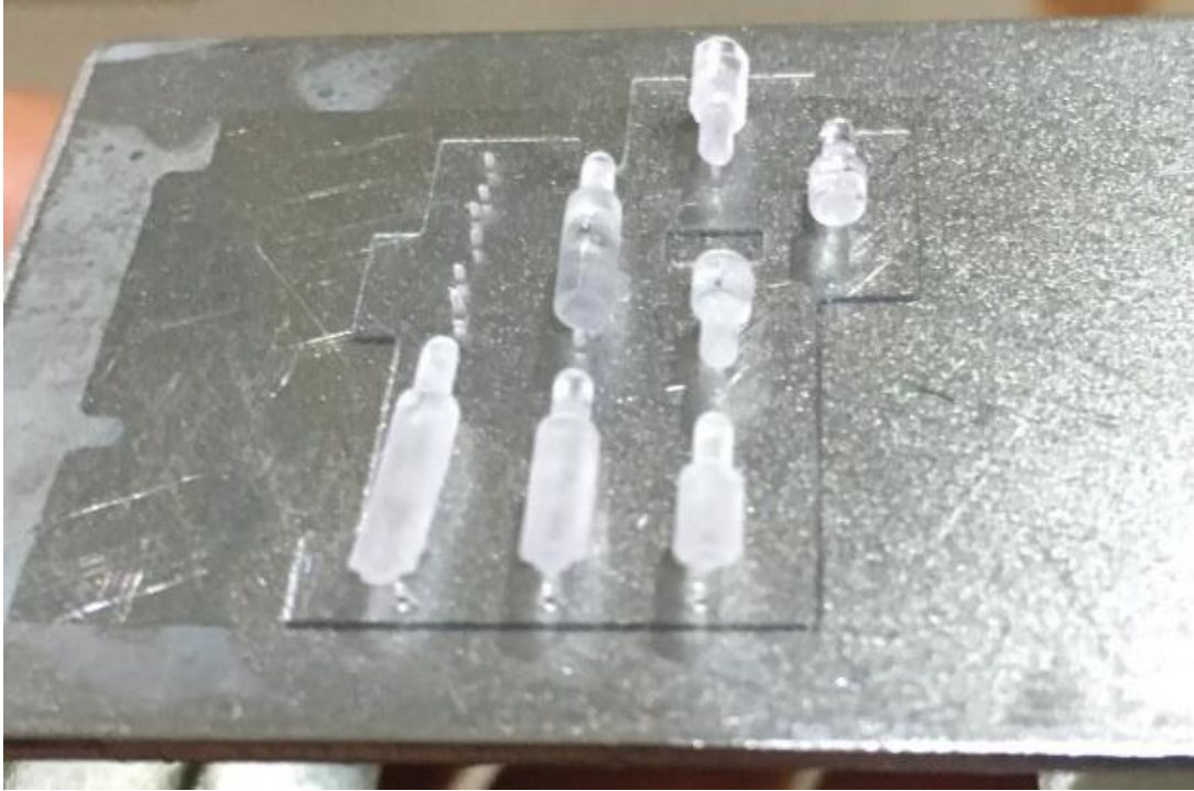
รูปที่ 1-6 ผลตัวอย่างการพิมพ์ด้วยเครื่องพิมพ์ 3 มิติแบบ SLA (ความละเอียด 140 um)
