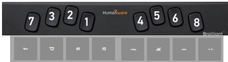
รูปที่ 2-19 รูปแบบการพิมพ์ตัวอักษรเบรลล์ในโหมต HW BI-40
