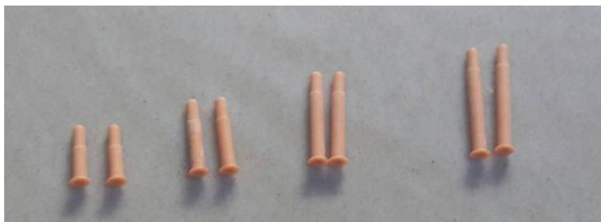
รูปที่ 6-4 Braille Pin ที่ทำจากวัสดุ Resin
