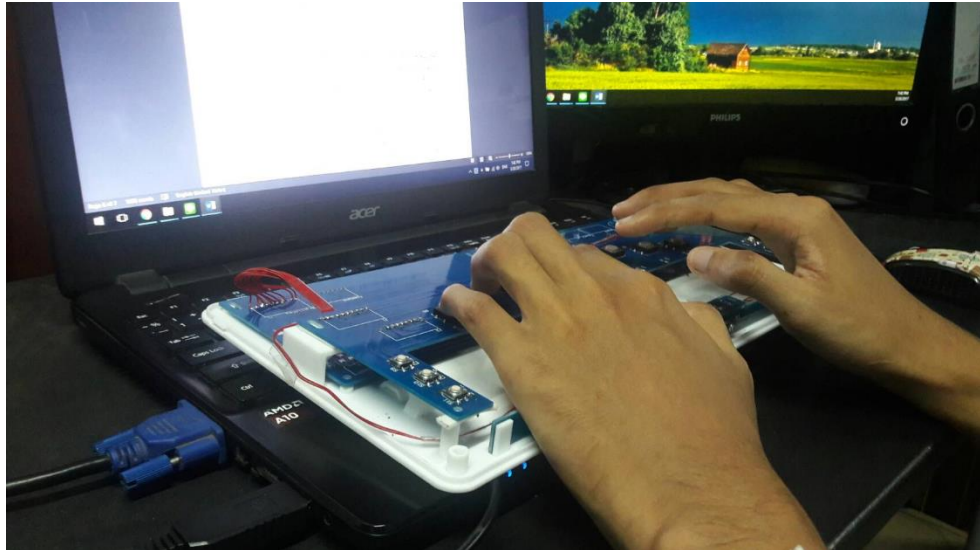
รูปที่ 3-4 การทดสอบการพิมพ์ข้อความไปยังคอมพิวเตอร์โดยใช้บอร์ดอักษรเบอร์ลล์
