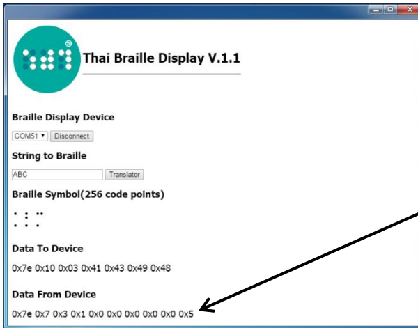
รูปที่ 3-12 การทดสอบการส่งข้อมูลปุ่มกดจากเครื่องไปยังคอมพิวเตอร์
