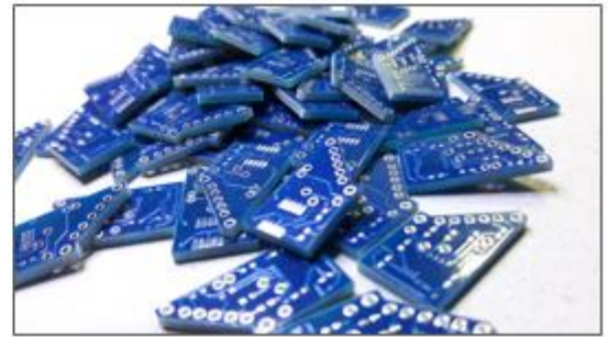
รูปที่ 3-5 แผ่นลายวงจรต่าง ๆ ที่ถูกออกแบบมาเพื่อใช้ในคีย์บอร์ดอักษรเบรลล์
