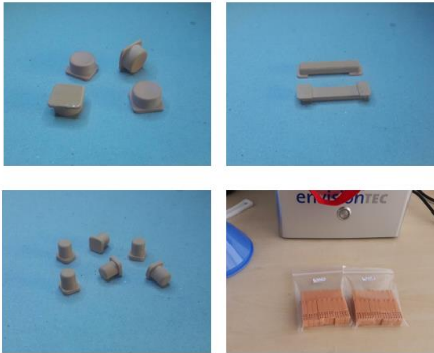
รูปที่ 3-23 ปุ่มกดและโมดูลแสดงผลที่ได้จากการพิมพ์สามมิติ
