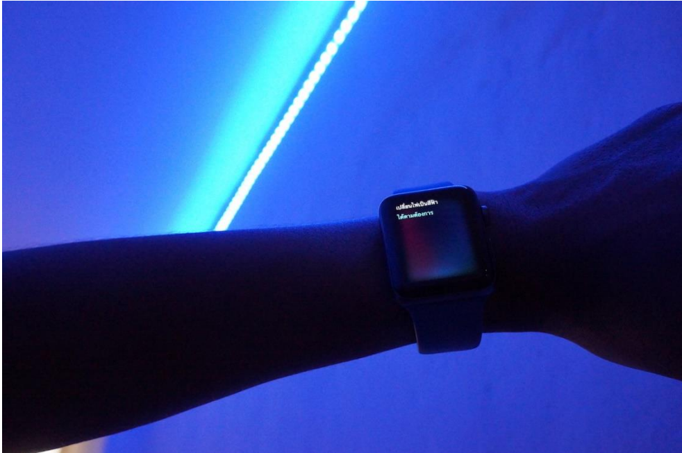
รูปที่ 20 การสั่งเปลี่ยนสี LED Strip ผ่าน Siri ของบ้านคุณแม่อมรพรรณ จังหวัดภูเก็ต จากรูปที่ 20 แสดงให้เห็นการควบคุมหลอดไฟแบบเปลี่ยนสีได้ โดยสามารถเลือกเปลี่ยนสีหลอดไฟได้ ตามใจชอบผ่านการเรียกใช้งาน Siri บน Smart Watch
