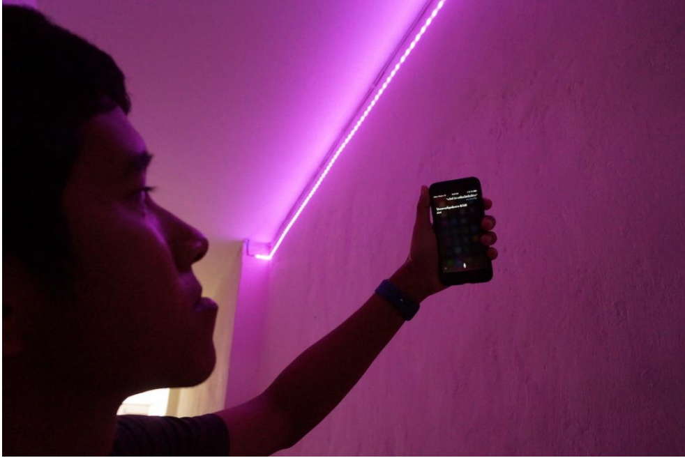
รูปที่ 19 การสั่งเปลี่ยนสี LED Strip ผ่าน Siri ของบ้านคุณแม่อมรพรรณ จังหวัดภูเก็ต จากรูปที่ 18 และรูปที่ 19 แสดงให้เห็นการควบคุมหลอดไฟแบบเปลี่ยนสีได้ โดยสามารถเลือกเปลี่ยน สีหลอดไฟได้ตามใจชอบผ่านการเรียกใช้งาน Siri บน iPhone
