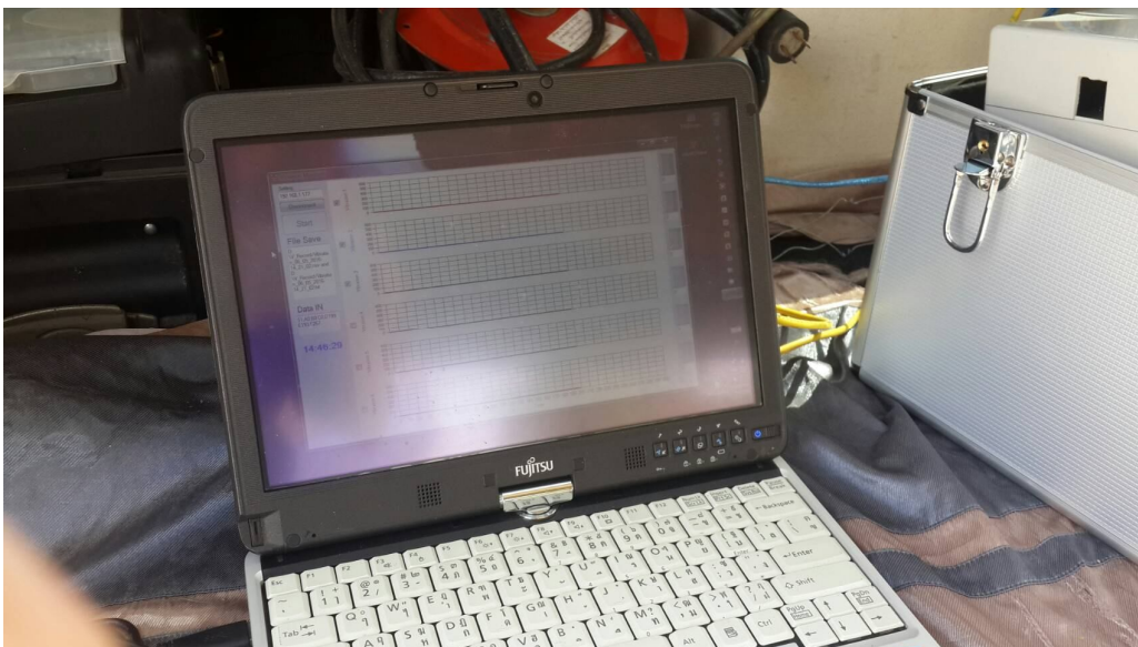
ภาพที่ 17 ระบบแสดงผลข้อมูลการวัดความเคลื่อนไหวของช้าง ทั้งหมด 6 ช่องสัญญาณ แต่ในการทดลองนี้ใช้เพียง 3 ช่องสัญญาณ
