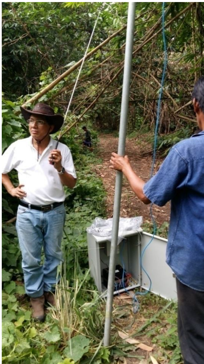
ภาพที่ 47 ระบบส่งสัญญาณของเครื่องวัดความสั่นสะเทือน
