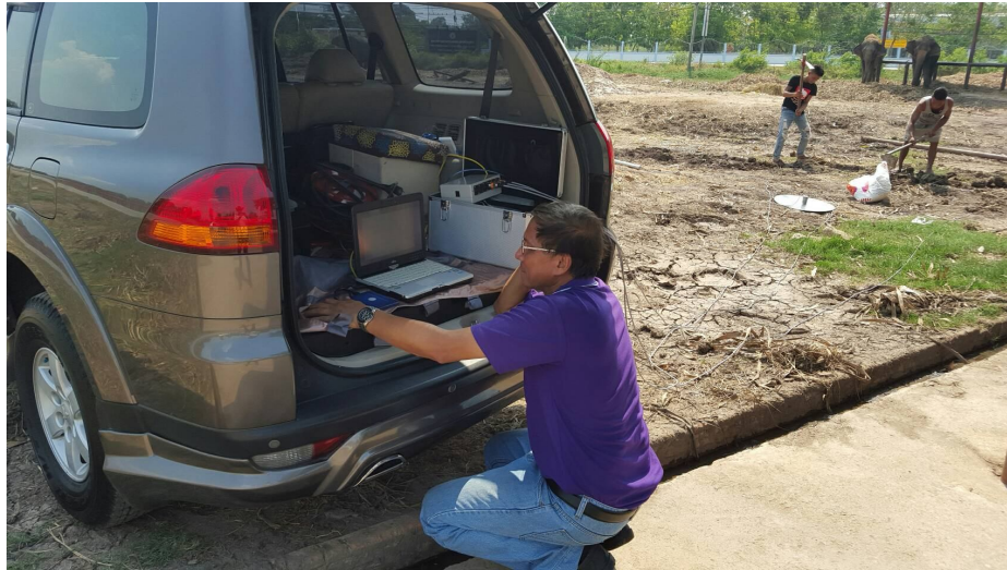
ภาพที่ 20 การทดสอบการทำงานของระบบก่อนการทดลองให้ช้างเดินในบริเวณที่ฝังตัวตรวจรู้
