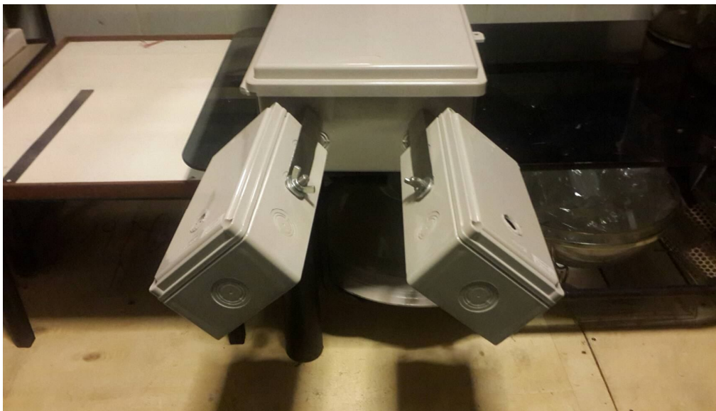
ก). การหมุนกล่องใส่กล้องอินฟราเรดหนึ่งแกน ภาพที่ 56 ตู้อุปกรณ์สำหรับระบบการตรวจจับภาพข้าง
