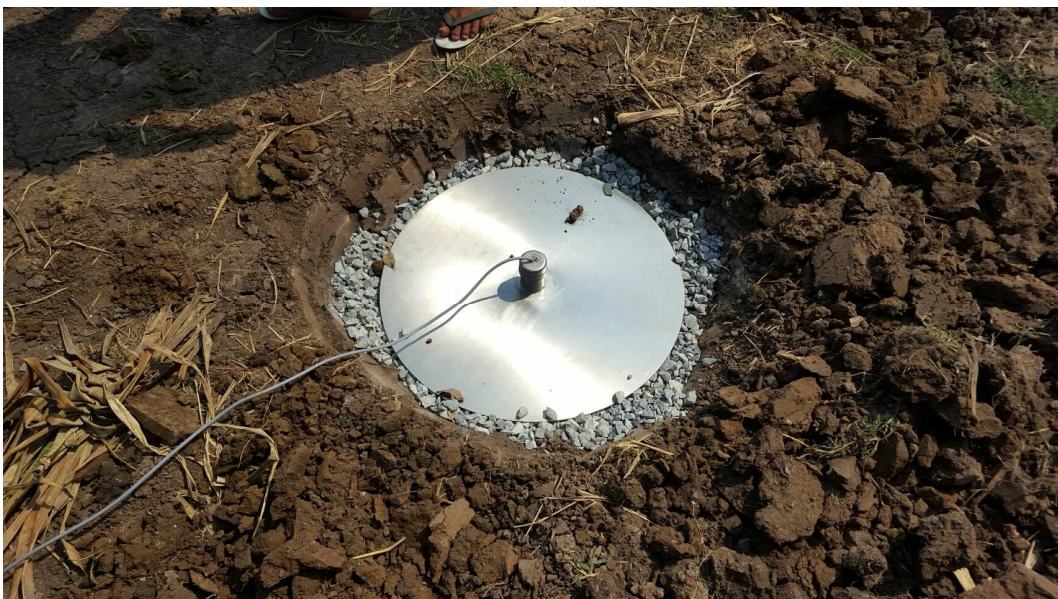
ภาพที่ 13 การวางตัวตรวจรู้แบบแผ่นกลมแบนบนหลุมเพื่อตรวจจับการเคลื่อนไหวของข้าง
