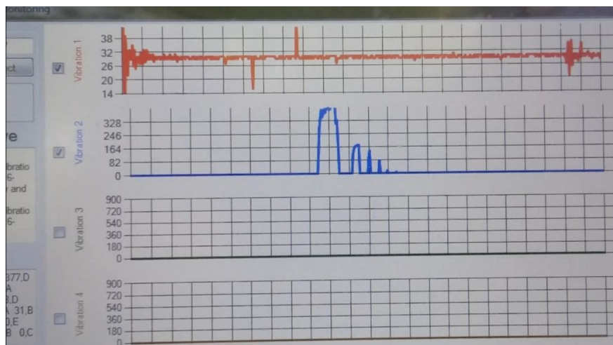
ภาพที่ 61 การรับสัญญาณคลื่นการสั่นสะเทือนจากตัวตรวจรู้แบบจีไอโฟน (สีแดง-แถวแรก) และตัวตรวจรู้แบบการวัดคลื่นการสั่นสะเทือน (สีน้ำเงิน-แถวที่สอง) ผ่านเครือข่ายคอมพิวเตอร์ จากบ้านเขากล้วย ตำบลพวา อำเภอแก่งหางแมว จันทบุรี
