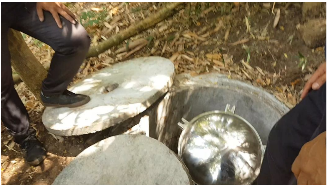
ภาพที่ 86 อุปกรณ์ตรวจจับคลื่นการสั่นสะเทือนในถังกักน้ำ ใบบ่อใต้ดิน
