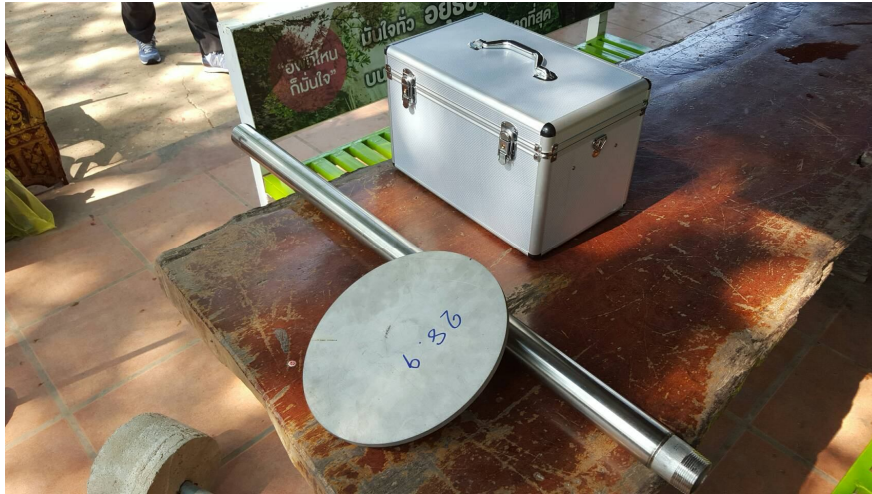
ภาพที่ 12 เปรียบเทียบตัวตรวจรู้แบบแผ่นกลมแบนทำจากสแตนเลสหนา 1.0 มม. ขนาดเส้นผ่าศูนย์กลาง 28.9 ซม. กับตัวตรวจรู้แบบที่สามเป็นลักษณะท่อโลหะกลมหนา 1.2 มม. เส้นผ่าศูนย์กลาง 5 ซม. ยาว 1 เมตร
