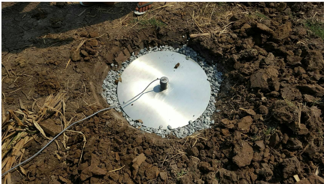
ภาพที่ 93 การฝังเซนเซอร์วัดคลื่นการสั่นสะเทือนแบบ vibration
