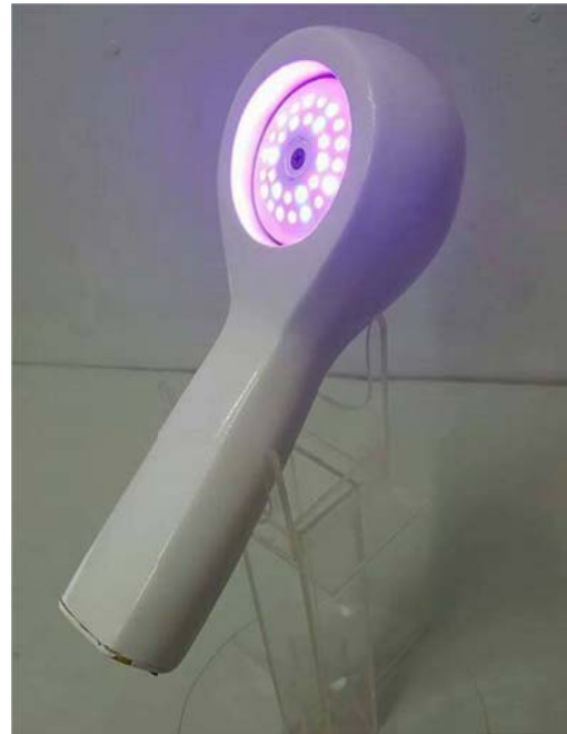
ภาพที่ 4.8 ชุดสาธิตเครื่องให้แสงแอลอีดีแบบมือถือเพื่อรักษาผิว
