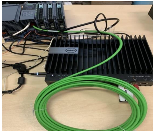
ภาพที่ 17 ชุดสาธิตการเชื่อมต่อและอ่านค่าจากอุปกรณ์ PLC โพรโทคอล OPC UA และ IoT Edge Gateway ไปสู่แพลตฟอร์ม NETPIE โดยใช้ Node-RED
