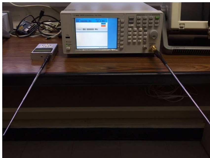
รูปที่ 3.15: การทดสอบความถูกต้องของระบบต้นแบบที่ใช้ระบบตรวจวัด การปรับเครื่องเข้าสู่ภาวะมาตรฐาน (Calibration) จากเครื่องสร้างสัญญาณ (Signal generator) แบบผ่านคลื่นความถี่ไร้สาย
