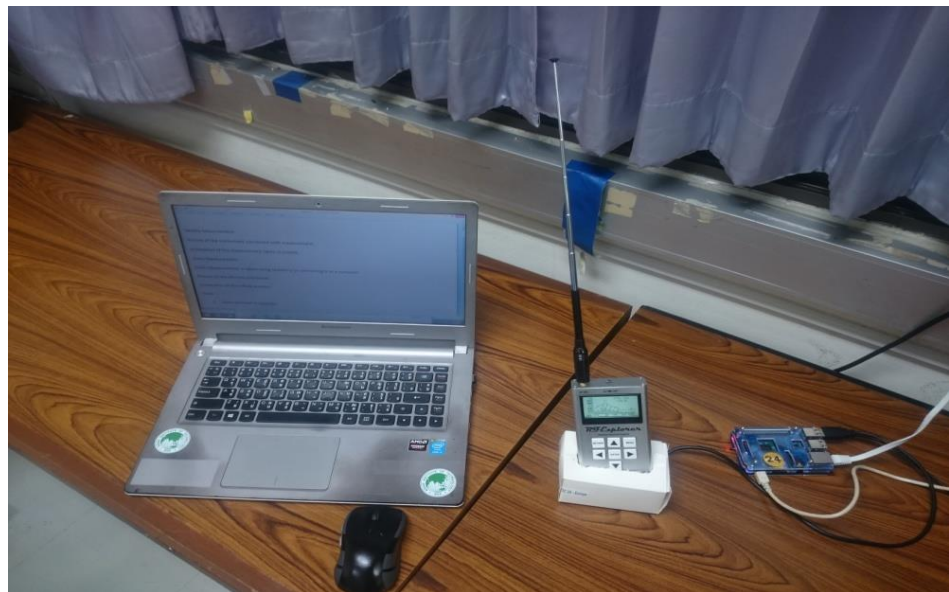
รูปที่ 3.9: แสดงการต่อเชื่อมเครื่องวิเคราะห์คลื่นสเปกตรัมแบบพกพา RF Explorer กับ รัสเบอร์รี่พาย
