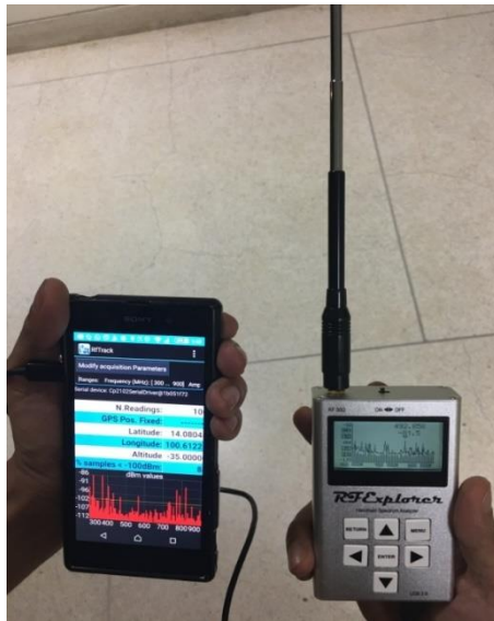
รูปที่ 3.6: เครื่องวิเคราะห์คลื่นสเปกตรัมแบบพกพา RF Explorer ต่อกับแอนดรอยด์ สมาร์ตโฟนผ่านสายเคเบิล OTG
