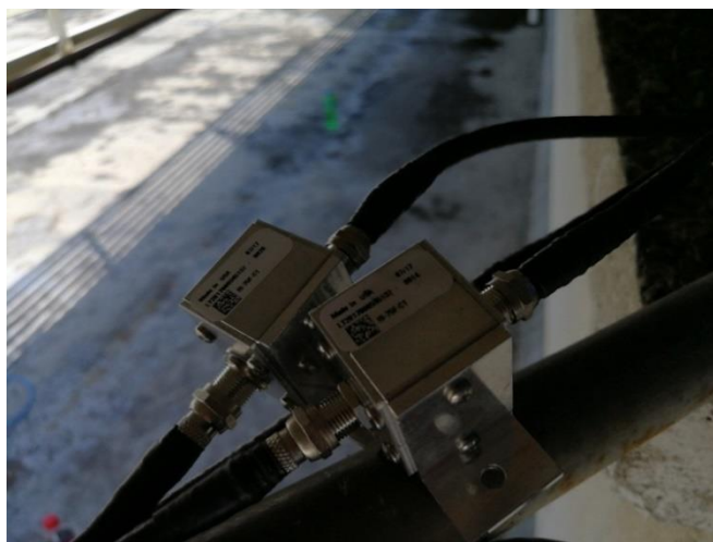
รูปที่ 3.22: การต่อเชื่อมสถานีฐานเข้ากับสายอากาศแบบแบ่งส่วน (เซ็กเตอร์)
