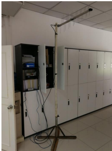
รูปที่ 3.24: สายอากาศแบบกำหนดทิศทางแบบล็อกเพอริโอดิกไดโพล (Log-periodic dipole antenna) ของส่วนอุปกรณ์รับสัญญาณ
