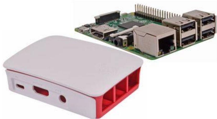
รูปที่ 3.8: ราวสเบอร์รี่พายรุ่น Raspberry Pi 3 Model B SBC พร้อมทั้งเคส
