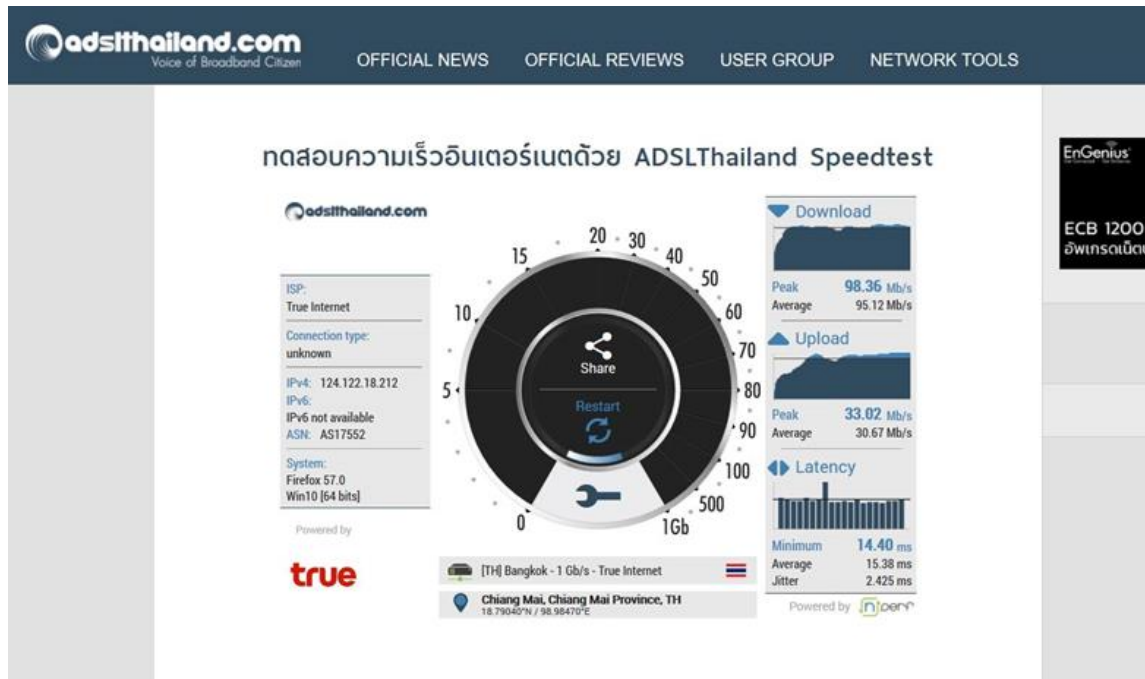
ภาพที่ 4.1.64 ภาพแสดงการทดสอบความเร็วสัญญาณอินเทอร์เน็ต วัดอุโมงค์สวนพุทธธรรม จังหวัดเชียงใหม่ ความเร็วที่ติดตั้ง 100/30 MBPs ความเร็วทดสอบ 96.12/30.67 MBPs
