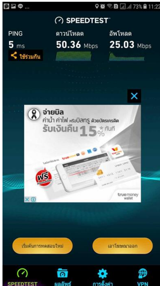
ภาพที่ 4.1.28 ภาพแสดงการทดสอบความเร็วสัญญาณอินเทอร์เน็ต วัดทองเนียม กรุงเทพมหานคร ความเร็วที่ติดตั้ง 50/20 MBPs ความเร็วทดสอบ 50.36/25.03 MBPs
