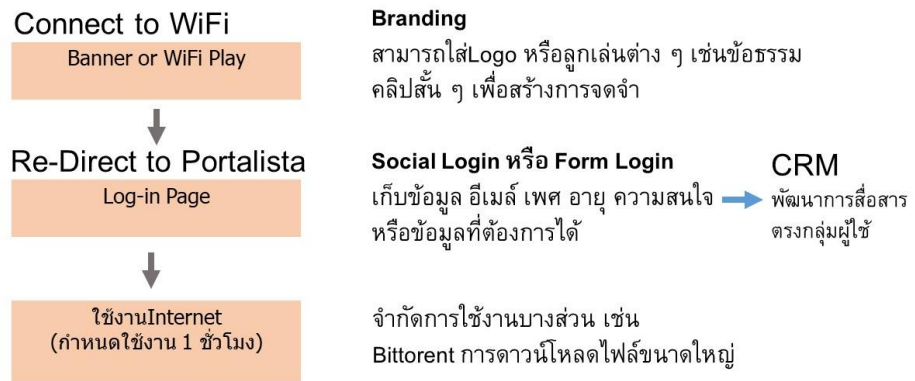
ภาพที่ 4.1.19 แผนภูมิแนวคิดการวางระบบเพื่อเข้าใช้งาน Free Wi-Fi
