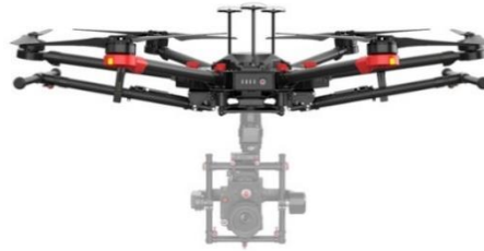
รูปที่ 5.29 แสดงการพับขาตั้งอากาศยานระหว่างบินเพื่อถ่ายภาพทางอากาศ
