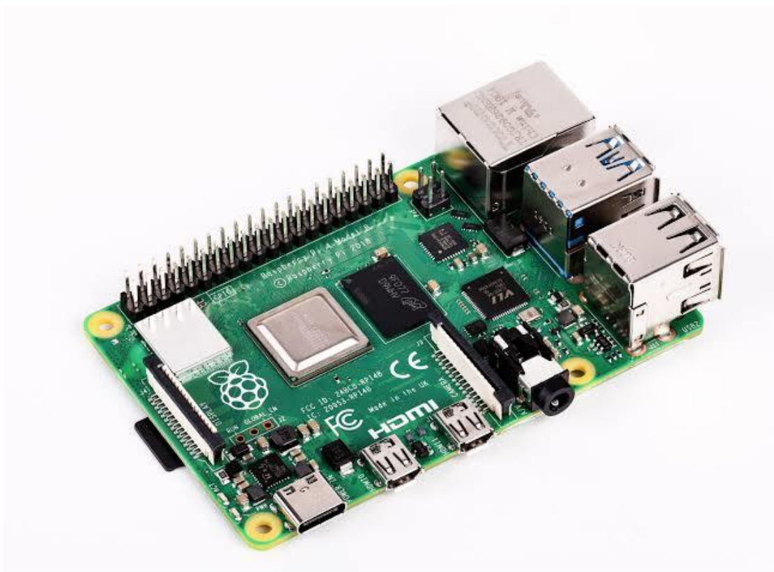
รูปที่ 5.44 บอร์ดคอมพิวเตอร์สำหรับพัฒนาโปรแกรม (เปลี่ยนแปลงจากเดิมที่ใช้ Manifold)
