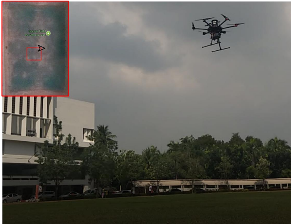
รูปที่ 6.31 ภาพการทดสอบอากาศยานบินตาม Waypoint ในตำแหน่ง Waypoint ที่ 1
