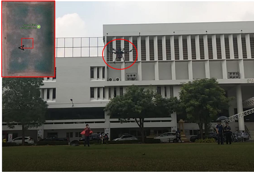
รูปที่ 6.33 ภาพการทดสอบอากาศยานบินตาม Waypoint ในตำแหน่ง Waypoint ที่ 3
