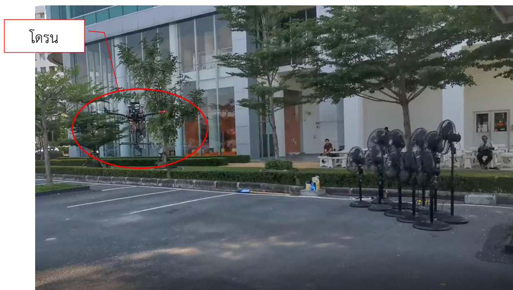
รูปที่ 6.69 การบินทดสอบต้านแรงลมของโดรน
