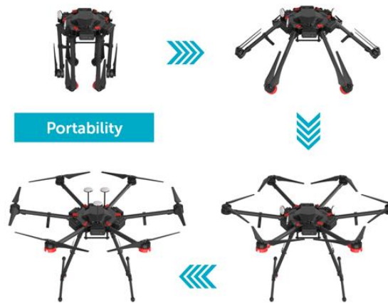
รูปที่ 5.28 แสดงการพับเก็บแขนเพื่อความสะดวกในการขนย้ายอากาศยาน
