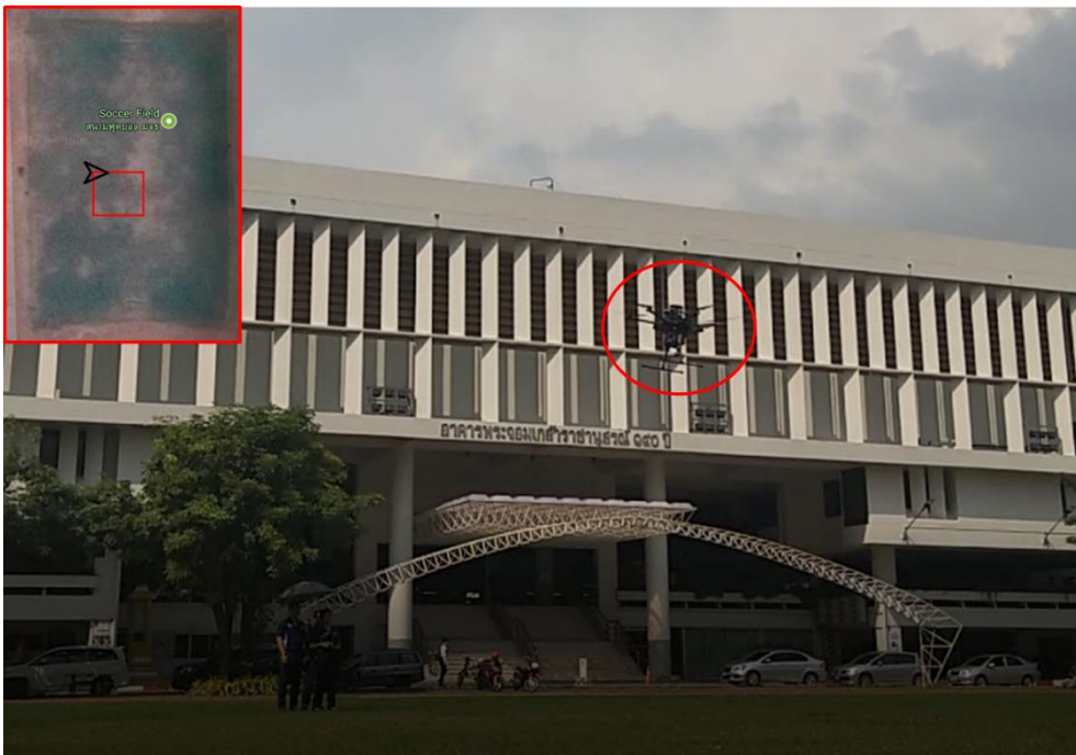
รูปที่ 6.30 ภาพการทดสอบอากาศยานบินตาม Waypoint หลังจาก Takeoff
