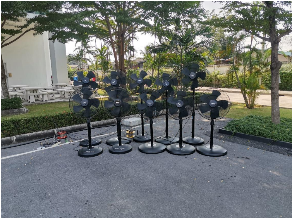
รูปที่ 6.67 พัดลมที่ใช้สร้างแรงลม เพื่อจำลองกระแสลมในการทดสอบ
