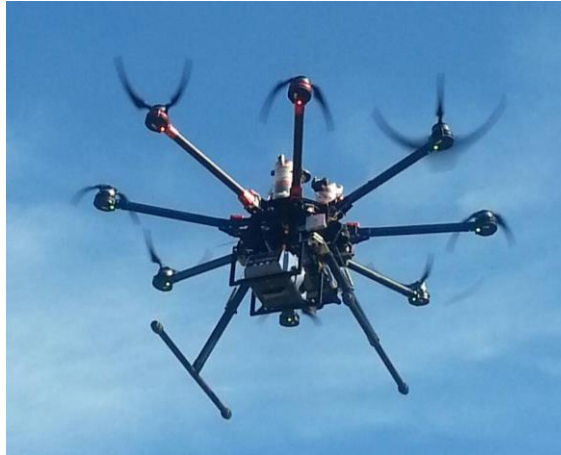
รูปที่ 2.6 Drone แบบปีกหมุนที่พัฒนาโดยพีโบบีและใช้ในการเก็บตัวอย่างฝุ่นในอากาศ
