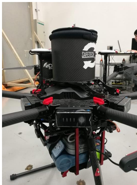
รูปที่ 5.34 แสดงตำแหน่งติดตั้งชุดโครงสร้าง AED
