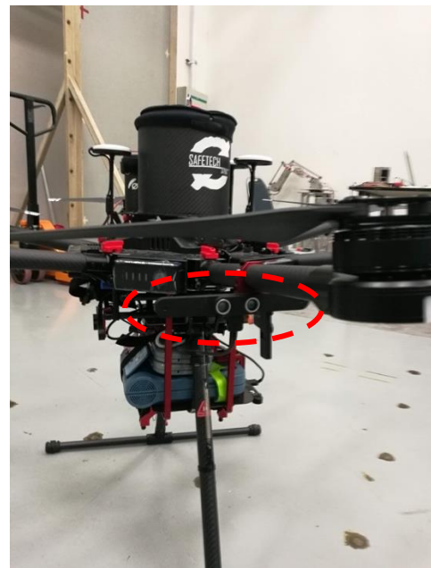
รูปที่ 5.39 แสดงตำแหน่งติดตั้งเซนเซอร์วัดระยะด้านซ้ายและขวา
