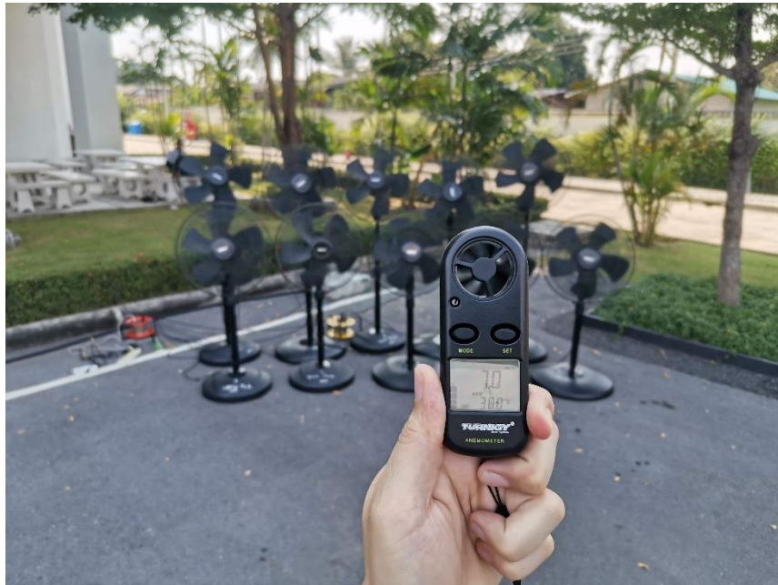
รูปที่ 6.68 ค่าแรงลมตำแหน่งที่โดรนทำการบินประมาณ 7 เมตร/วินาที
