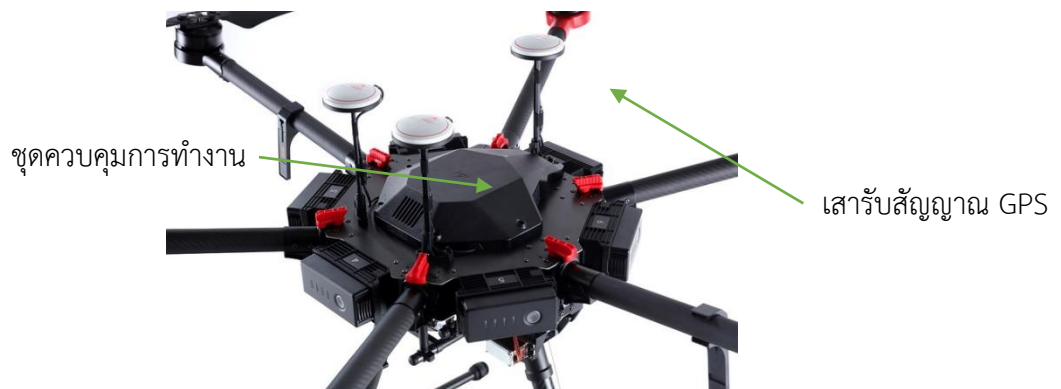
รูปที่ 5.27 แสดงชุดควบคุมการทำงาน และเสารับสัญญาณ GPS บนอากาศยาน
