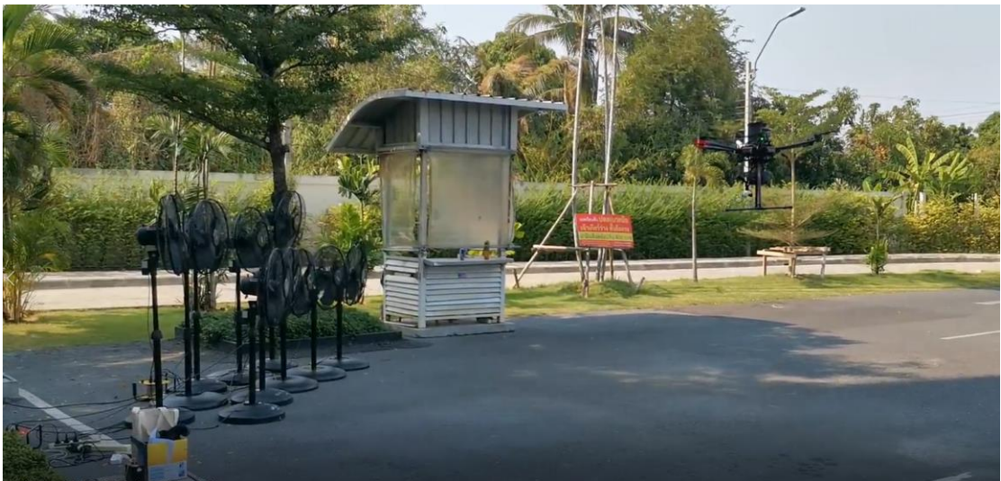
รูปที่ 6.70 ทดสอบการบินต้านลมขณะทำการบินขึ้น (Take off)
