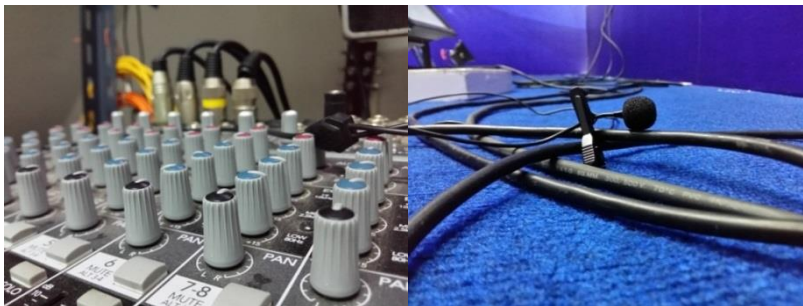
รูปที่ ๑๖๖-๑๖๗ เครื่องมิกซ์เสียง และไมค์สาย สำหรับใช้ในห้องสตูดิโอชุมชน
