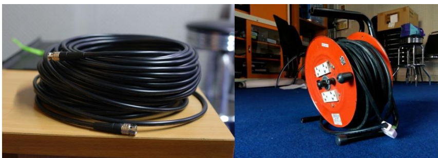
รูปที่ ๑๗๐-๑๗๑ สายสัญญาณกล่อง L-๔.๕ CHD Canare/สายไฟต่ออุปกรณ์
