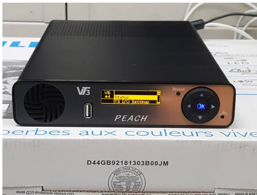
ภาพที่ 6 DVB subtitle generator ยี่ห้อ Peach software control รุ่น VB2000
