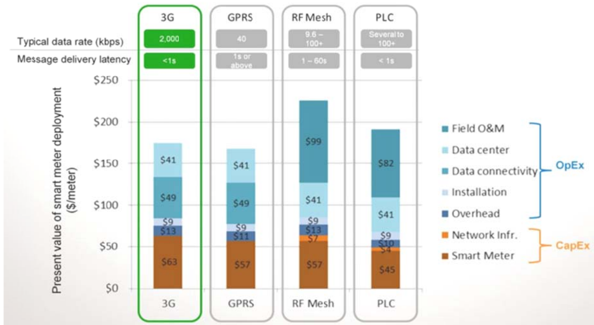
รูปที่ 7-4 เปรียบเทียบ Total Cost of Ownership ระหว่างเทคโนโลยี 3G/GPRS/RF Mesh/PLC
