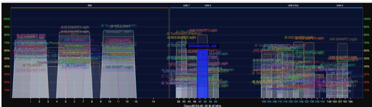
รูปที่ 8.1 การใช้งานช่องสัญญาณตามมาตรฐาน IEEE 802.11 ในย่านความถี่ 2.4 GHz และ 5 GHz ในบริเวณพื้นที่นำร่อง Smart Metro Grid ของ กฟน.
