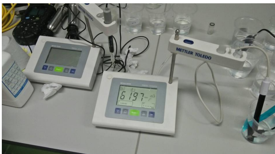
ภาพที่.3-12 เครื่องมือในการสอบเทียบเครื่องวัดคุณภาพน้ำเครื่องวัดที่ใช้สอบเทียบที่ห้องปฏิบัติการ
