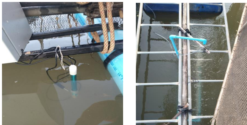
ภาพที่ 3-48 ทดสอบเครื่องวัดคุณภาพน้ำและการเติมอากาศที่บ้านห่อม
