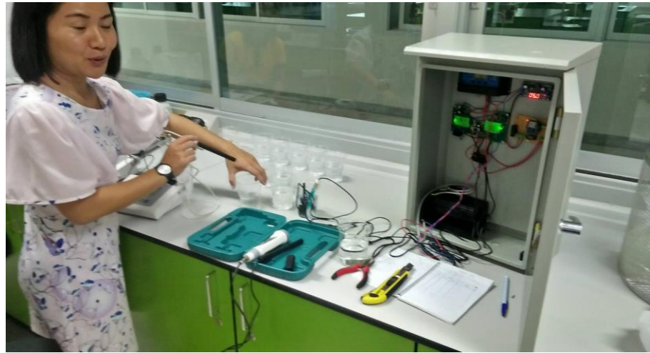
ภาพที่.3-19 การทดสอบชุดตรวจวัดและส่งสัญญาณไปแสดงผลที่แอปพลิเคชันไลน์ ในโทรศัพท์เคลื่อนที่และไปสั่งให้ชุดเติมอากาศเปิดโซลินอยด์วาล์วเปิดออกซิเจนไปเติมอากาศให้ กระชังปลา
