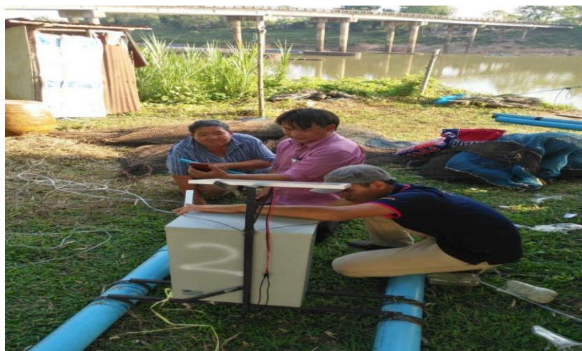
ภาพที่.3-36 การทดสอบการควบคุมมาสั่งการให้ชุดเติมอากาศทำงานผ่านรีโมตจากชุดตรวจวัด คุณภาพน้ำที่บ้านหาดกวน
