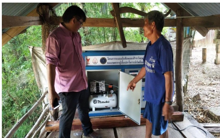
ภาพที่. 3-25 การทดสอบการควบคุมมาสั่งการให้ชุดเติมอากาศทำงานผ่านรีโมตจากชุดตรวจวัด คุณภาพน้ำ
