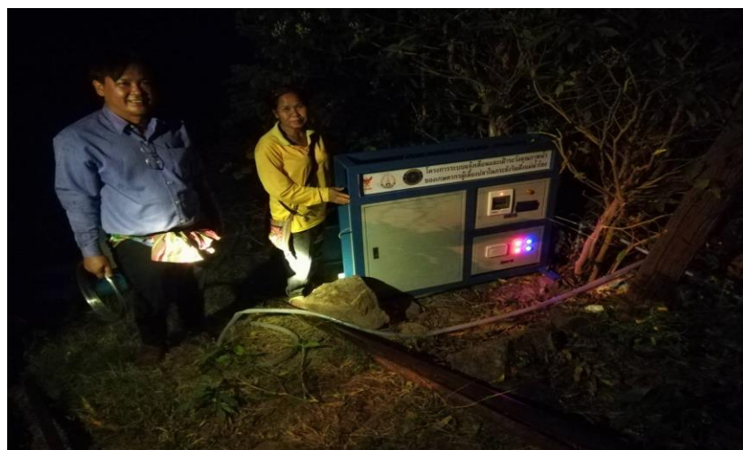
ภาพที่ 3-61 การทดสอบการควบคุมมาสั่งการให้ชุดเติมอากาศทำงานผ่านรีโมตจาก ชุดตรวจวัดคุณภาพน้ำ
