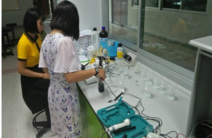
ภาพที่.3-14 การสอบเทียบชุดตรวจวัด pH กับเครื่องมือวัดค่า pH ที่ห้องปฏิบัติการ
