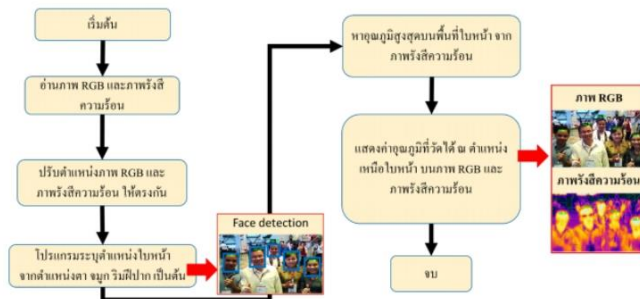
รูปที่ ๕ ภาพแสดงถึงกระบวนการประมวลผลภาพระบุตำแหน่งหน้าคน และระบุอุณหภูมิ ในต้นแบบ \mu Therm Smartphone และ \mu Therm Comfort
