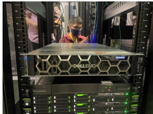
รูปที่ 51 ภาพด้านหน้าของเครื่องคอมพิวเตอร์แม่ข่ายหลังติดตั้งที่ตู้ rack
