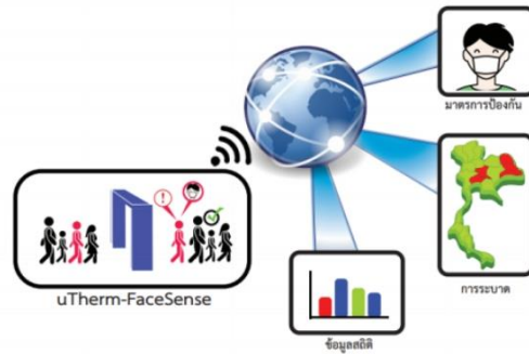
รูปที่ ๓ แสดงรูปแบบการใช้งานระบบ \mu Therm-FaceSense โดยมีการเชื่อมต่อกับโครงข่ายอินเทอร์เน็ตไร้สายเพื่อส่ง ข้อมูลที่เป็นประโยชน์ในการเฝ้าระวัง และกำหนดมาตรการในการลดการแพร่กระจายของโรคติดต่อ หรือการสูญเสีย
