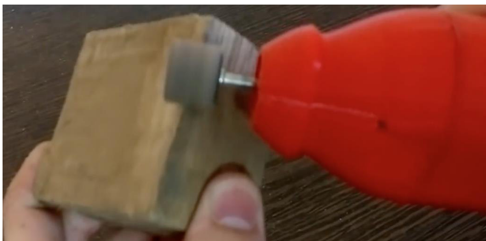
รูปที่ 72 : การใช้ Dremel ในการขัดผิวชิ้นงาน
