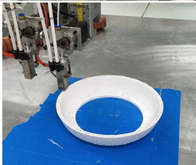
รูปที่ 71 : ตัวอย่างชิ้นงานที่ขึ้นรูปด้วยเครื่องพิมพ์สามมิติชนิด FDM
