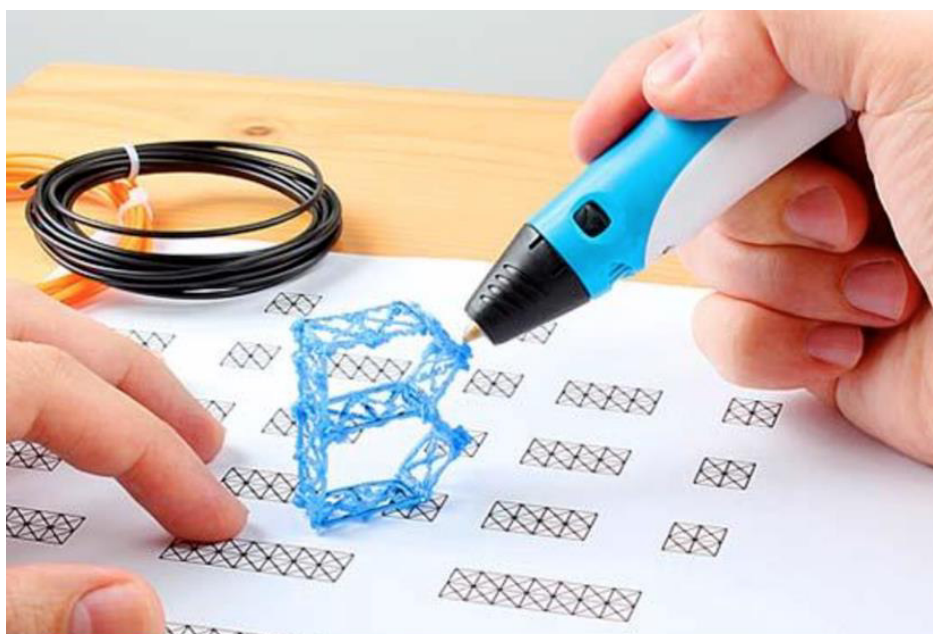
รูปที่ 73 : ตัวอย่างการเติมเนื้อชิ้นงานด้วยปากกา 3 มิติ
