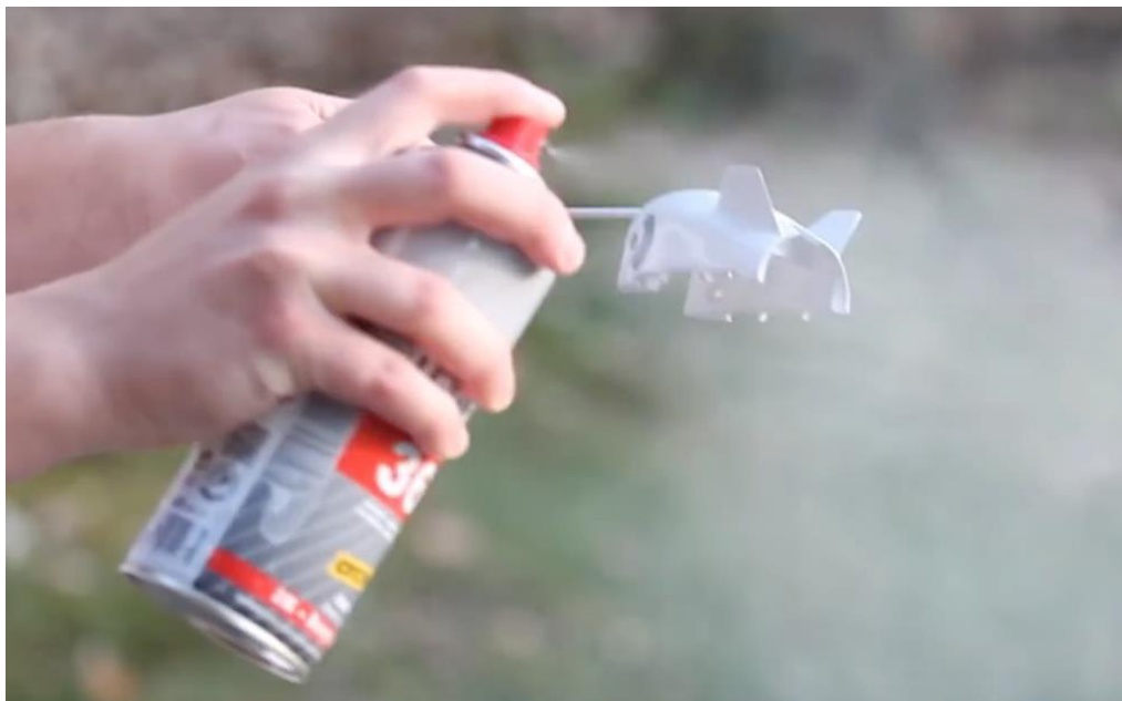
รูปที่ 75 : ตัวอย่างวิธีการเติมเนื้อชิ้นงานด้วย Spray Filler
