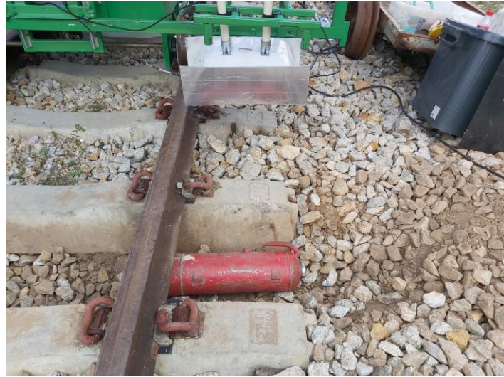
รูปที่ 147 การทดสอบการวางถังดับเพลิงไว้ใต้รางรถไฟ
