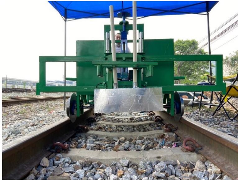
รูปที่ 122 การทดสอบรางรถไฟเพื่อกำหนดจุดอ้างอิง
