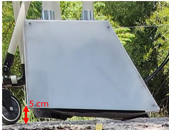
รูปที่ 69 ชุดสายอากาศที่ติดตั้งกับรถเข็นต้นแบบ
