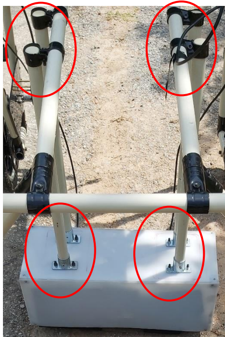
รูปที่ 68 จุดยึดนอต 2 ตัวระหว่างโครงสร้างตัวจับยึดกับชุดอุปกรณ์สร้างสัญญาณเรดาร์
