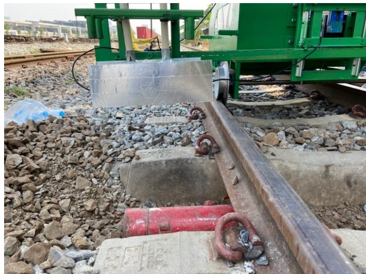
รูปที่ 129 การทดสอบการวางวัตถุไว้ใต้รางรถไฟ
