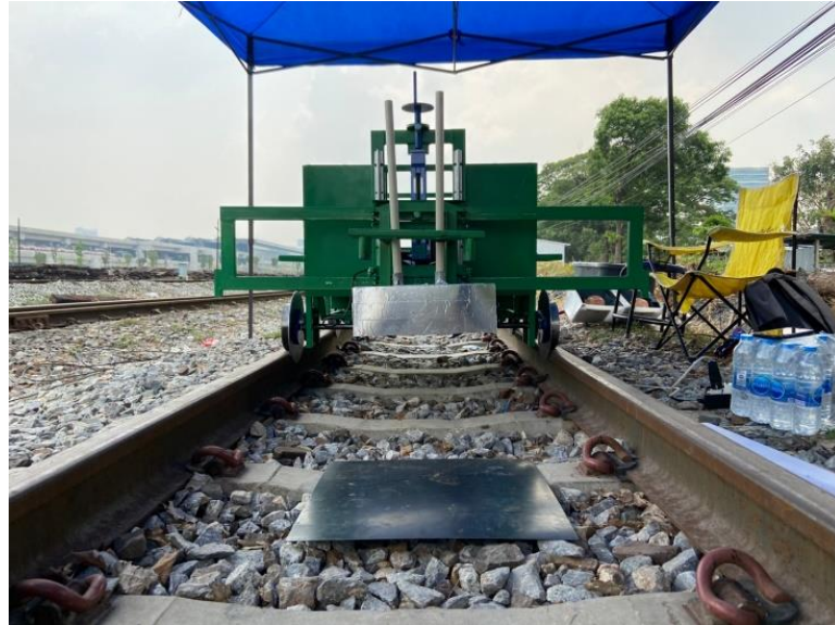
รูปที่ 120 การทดสอบแผ่นเหล็กเพื่อกำหนดจุดอ้างอิง
