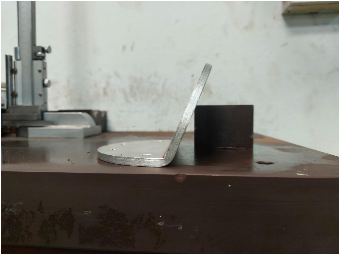
รูปที่ 1.8 เพลตยึดกล่องของอุปกรณ์ติดตามช้างป่า
