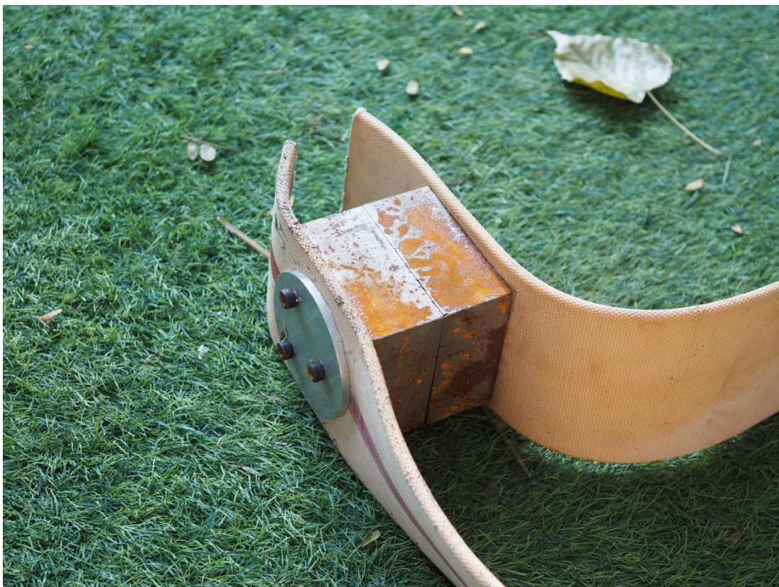
รูปที่ 2.3 การประกอบปลอกคออุปกรณ์ติดตามข้าง
