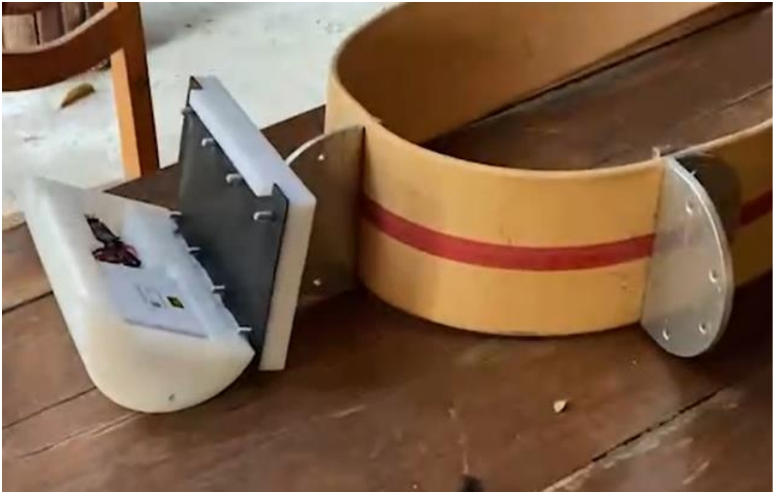
ปที่ 2.2 การฉนีกกล่องเก็บอุปกรณ์ติดตามช้างป่า เพื่อเตรียมนำไปติดตั้งกับปลอกคออุปกรณ์ติดตามช้าง
