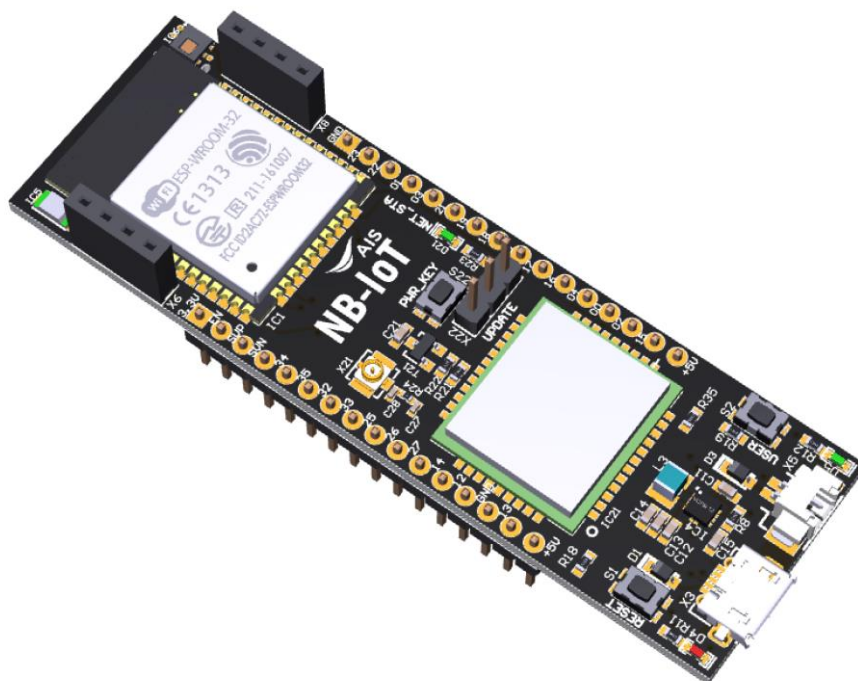
รูปที่ 4.31 บอร์ด DEVIO NB-DEVKIT ของบริษัทเอไอเอส
