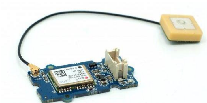
รูปที่ 4.19 โมดูล GPS รุ่น Grove - GPS V1.2 พร้อมสายอากาศแบบแยกส่วน
