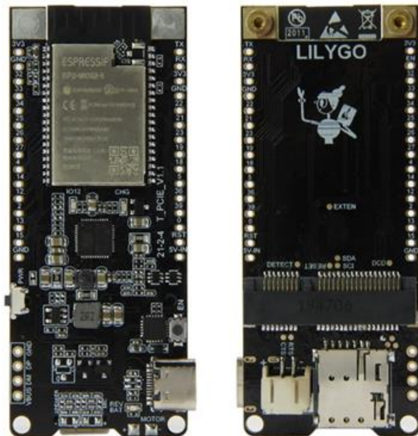
รูปที่ 7.4 บอร์ด TTGO T-PCIE ของบริษัท LILYGO
