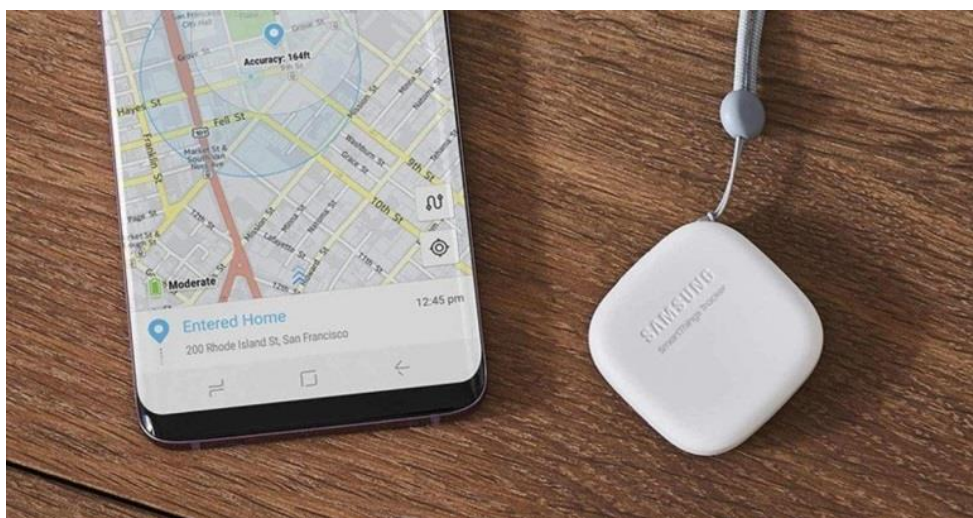
รูปที่ 3.6 อุปกรณ์ติดตามที่ใช้หลายสัญญาณร่วมกัน 11
