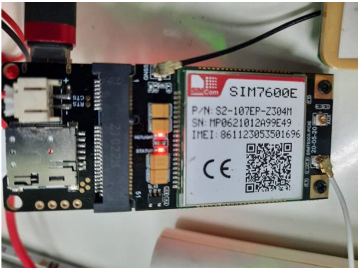
รูปที่ 7.14 วงจรภายในปลอกคอกอุปกรณ์ติดตามช้างป่าขณะทำงาน
