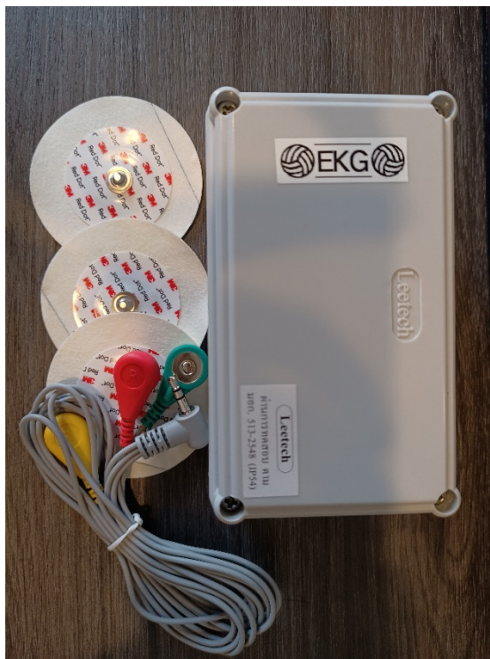
รูปที่ 3 อุปกรณ์วัดคลื่นไฟฟ้าหัวใจ
