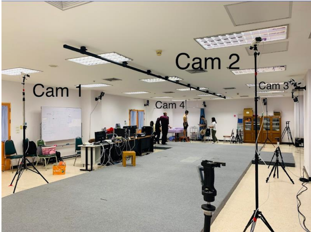
รูปที่ 27 การติดตั้งกล้องจริง ณ ห้องที่ใช้ในการเก็บบันทึกข้อมูล ณ มหาวิทยาลัยมหิดล
