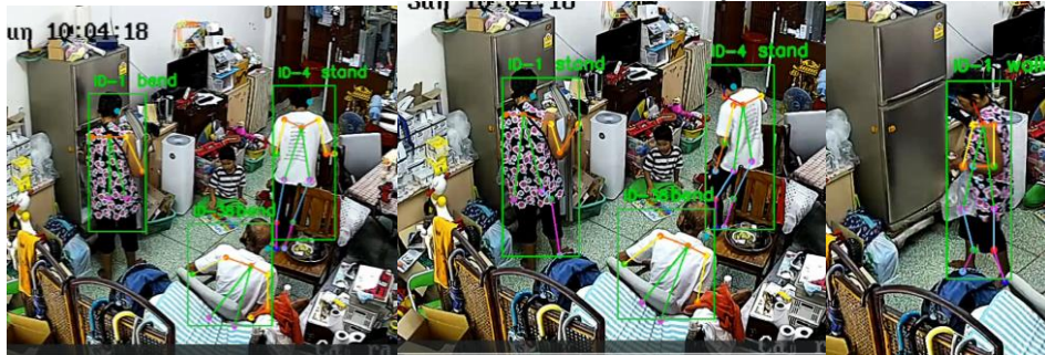
รูปที่ 75 ผลการแยกแยะประเภทกิจกรรม (ท่าทาง) บนชุดข้อมูลทดสอบ (unseen dataset) ในมุมกล้องวงจรปิดที่ติดตั้งอยู่แล้วในบ้านของทีมวิจัย
