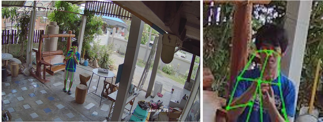
รูปที่ 11 จุดสี่เหลี่ยมแสดงตัวอย่างตำแหน่ง ตา หู และจมูก (ขวา) ซึ่งถูกนำมาพิจารณาในการเลือกเฟรม (ซ้าย) เพื่อใช้ในการรู้จำใบหน้า
