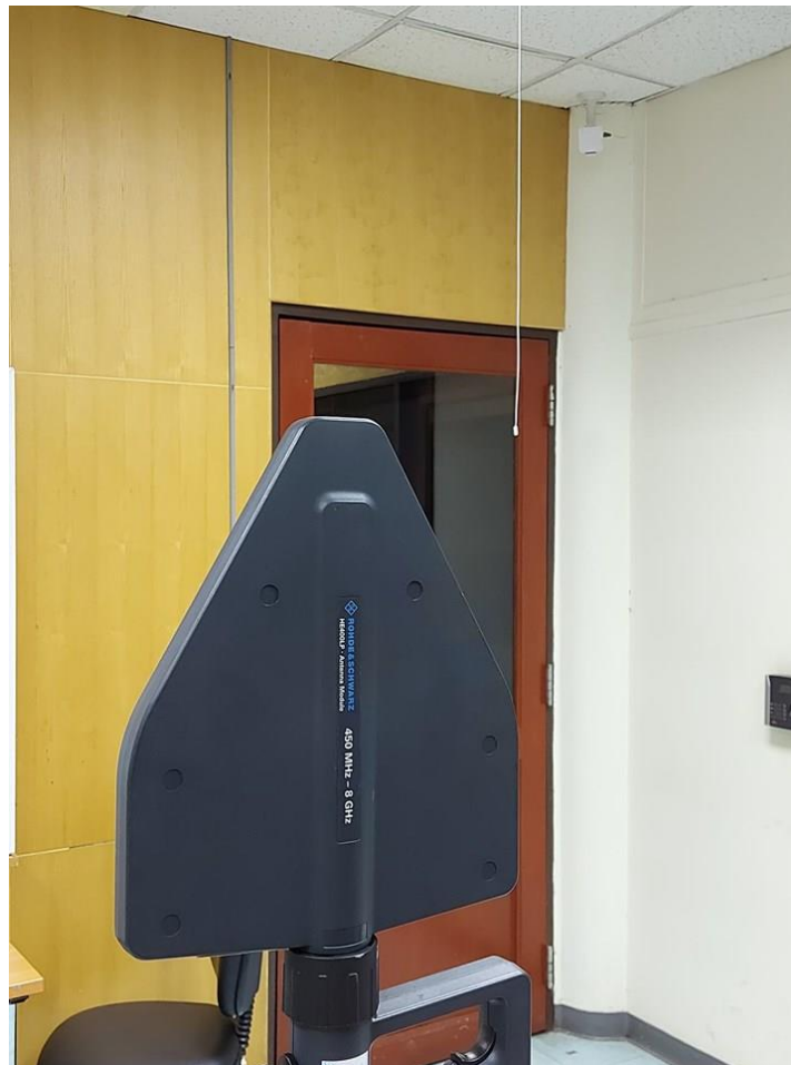
ภาพที่ 22 Antenna วัดสัญญาณ ครอบคลุมความถี่ถึง 8 GHz.
