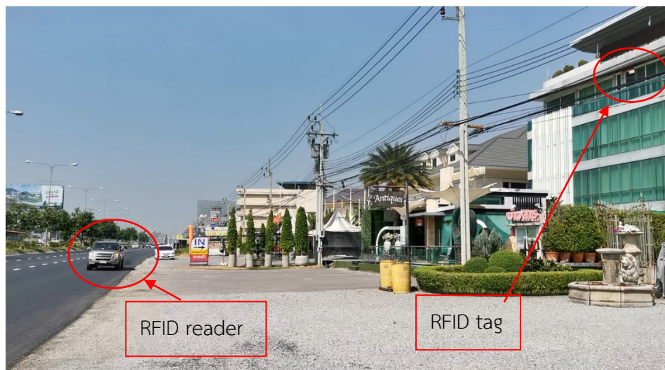
รูปที่ 90 การอ่านค่าจาก RFID tag เมื่อขับรถผ่าน
