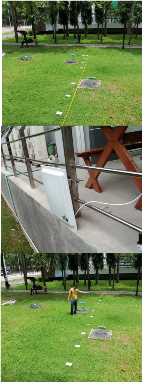
รูปที่ 36 การวัดระยะการอ่านในแนวราบของ RFID Tag
