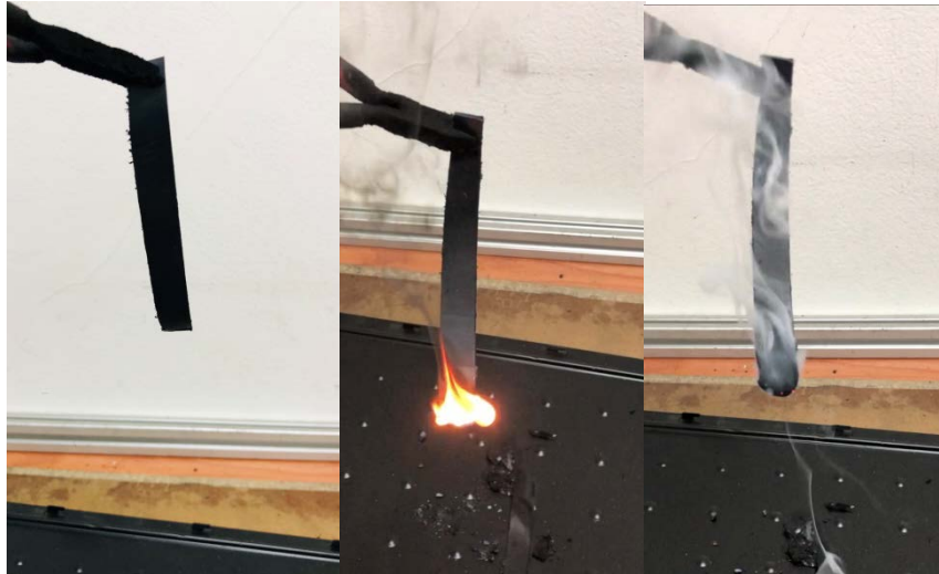
รูปที่ 73 แสดงขึ้นตัวอย่างของท่อป้องกันในแท่นจับยึดทดสอบการติดไฟแนวตั้ง และขึ้นตัวอย่างในแท่นจับยึดขณะติดไฟแล้วเริ่มจับเวลาเมื่อเอาไฟออกจนดับ และระยะเวลาหลังไฟดับแล้วเกิดการหดร่นจนหยุด แล้วบันทึกเวลา
