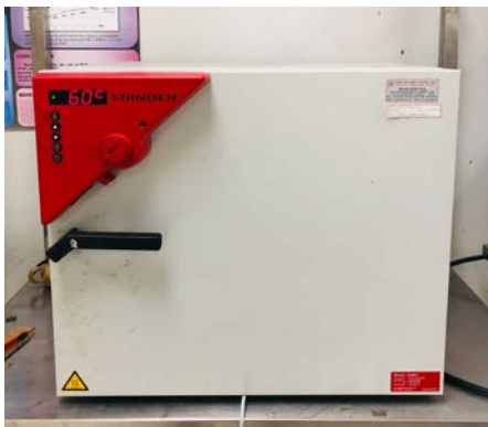
รูปที่ 68 เตาอบความคุมอุณหภูมิ การทดสอบความชื้นและรังสี UV ตาม ASTM G 154-00A
