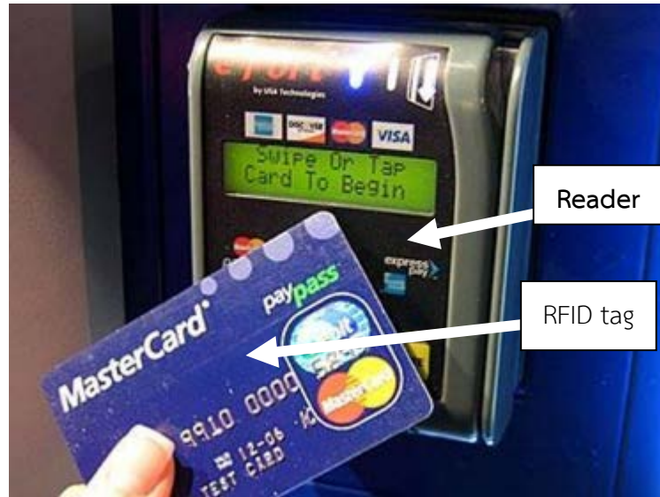
รูปที่ 12 ตัวอย่างการใช้งาน RFID tag และตัวอ่านข้อมูล (Reader)
