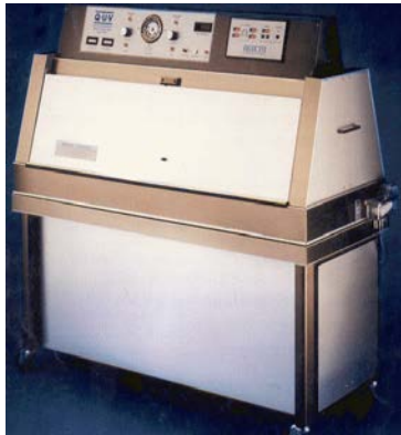
รูปที่ 67 เครื่อง QUV Accelerated Weathering และหลักการทำงานตาม ASTM G 154-00A
