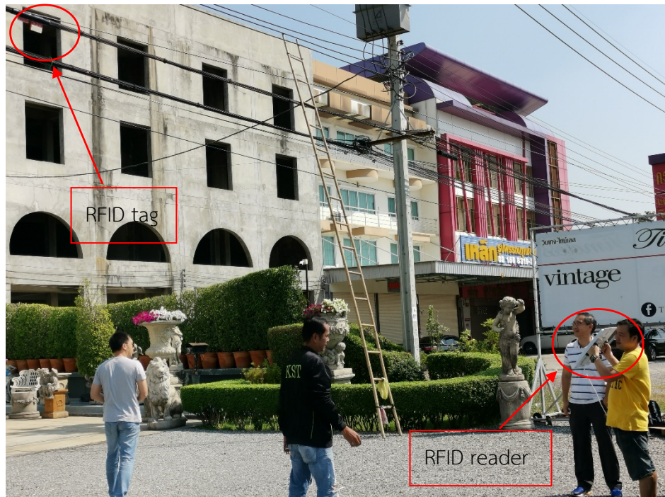
รูปที่ 89 การอ่านค่าจาก RFID tag เมื่ออ่านโดย RFID reader ที่อยู่กับที่
