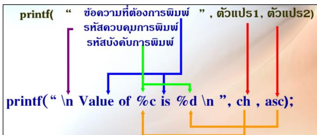
ภาพที่ ๕๓ แสดงตัวอย่างการคำสั่งการแสดงผลข้อมูลในภาษา C
