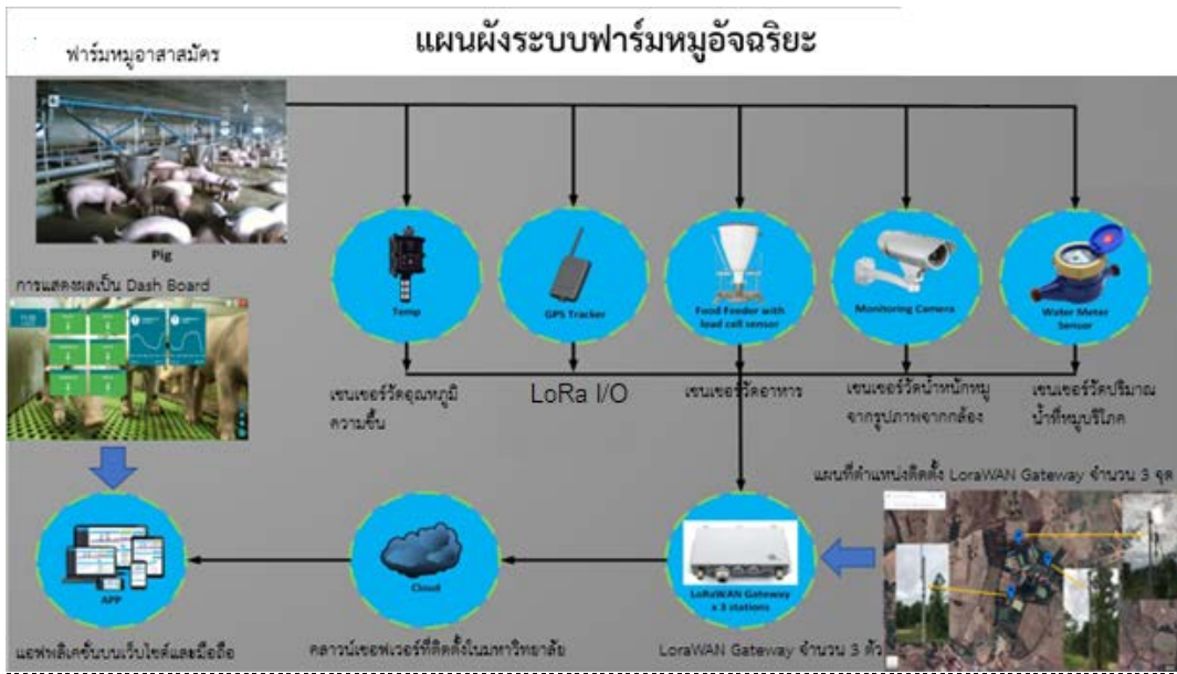
รูปที่ 25 รูปแสดงแนวความคิดในการติดตั้งระบบฟาร์มหมูอัจฉริยะ
