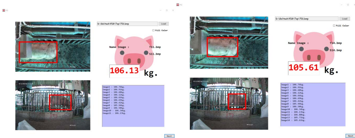
รูปที่ 63 การอ่านค่าน้ำหนักหมูด้วยภาพสำหรับตัวอย่างหมูตัวที่ 9 และ 10
