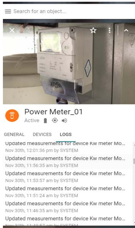
รูปที่ 67 ค่าผลการวัดพลังงานไฟฟ้าจากมิเตอร์วัดกำลังไฟฟ้าที่สามารถเชื่อมต่อกับอุปกรณ์ I/O ของ LoRa Node
