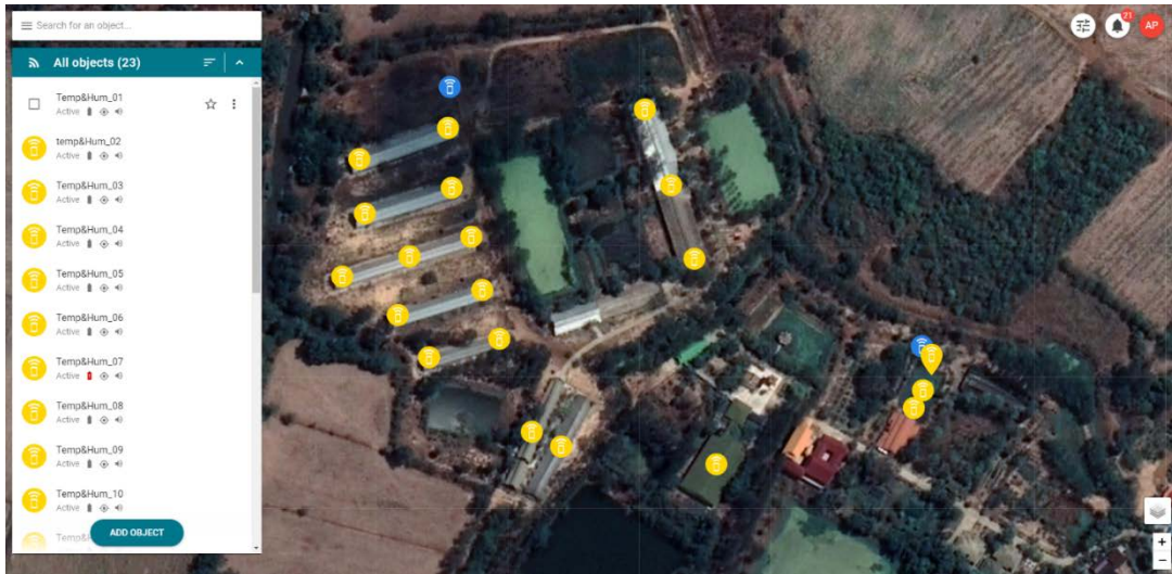
รูปที่ 33 การติดตั้งจำนวนเซนเซอร์อุณหภูมิและความชื้นทั้ง 20 ชุดในเล้าหมู
