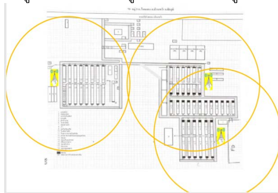
รูปที่ 26 รูปแสดงการวางตำแหน่งตั้งเสา LoRaWAN Gateway หลัก เพื่อทำการติดตั้งโครงข่าย
