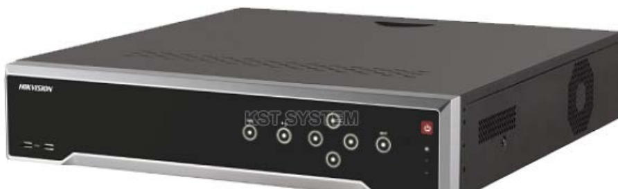
รูปที่ 46 ระบบเก็บข้อมูลภาพหมู่เพื่อใช้ในการวัดน้ำหนักของหมูภายในกรงหมูที่สร้างขึ้นพร้อมลง Harddisk จำนวน 6 TB
