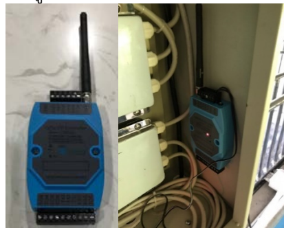
รูปที่ 32 LoRa I/O เพื่อใช้ในการส่งข้อมูลต่างๆจากเซนเซอร์ภายในเล้าหมูไปยังเครือข่าย LoRAWAN
