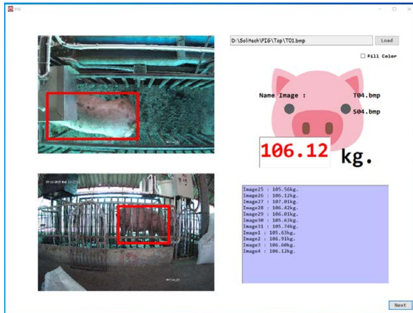
รูปที่ 53 โปรแกรมตรวจสอบน้ำหนักหมูด้วยภาพ
