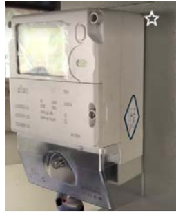
รูปที่ 66 มิเตอร์วัดกำลังไฟฟ้าที่สามารถเชื่อมต่อกับอุปกรณ์ I/O ของ LoRa Node
