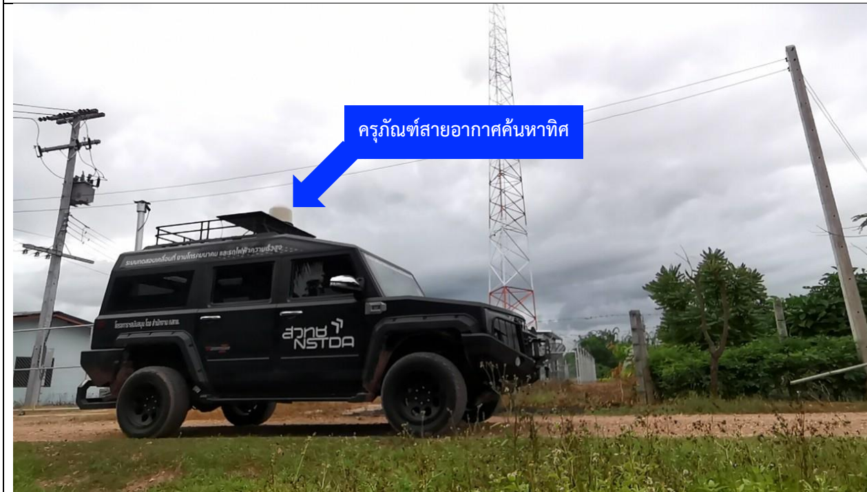
ภาพแสดงการติดตั้ง ครุภัณฑ์ชุดเครื่องมือวัดและค้นหาทิศทางของสถานีส่งในรถโมบายแลป(ต่อ)
