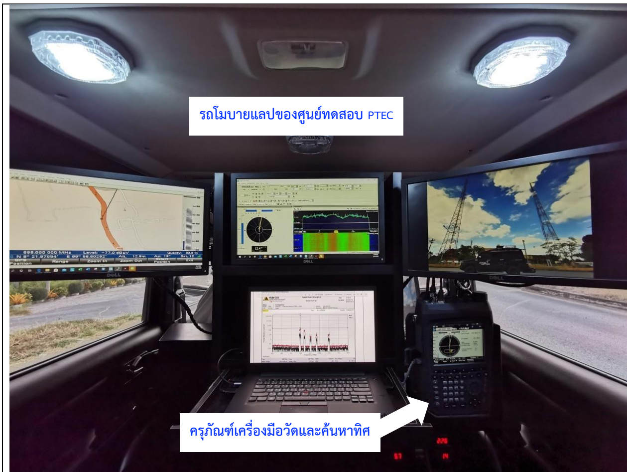
ภาพแสดงการติดตั้ง ครุภัณฑ์ชุดเครื่องมือวัดและค้นหาทิศทางของสถานีส่งภายในรถโมบายแลป
