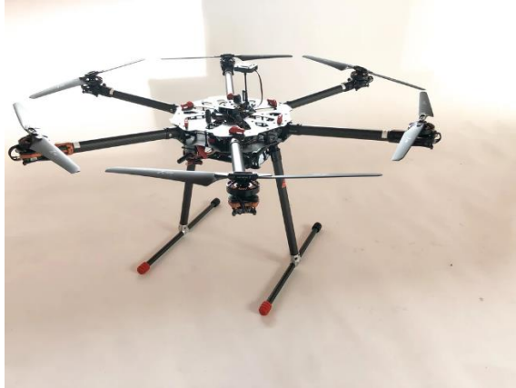
รูปที่ 47 อากาศยานไร้คนขับแบบปีกหมุน 6 แขน 6 ใบพัด Tarot X6 V 2.1
