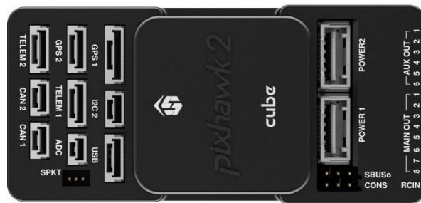
รูปที่ 52 ส่วนเชื่อมต่อของ Pixhawk 2.1
