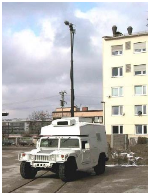
รูปที่ 8 สายอากาศแบบมีทิศทางเพียงต้นเดียวซึ่งสามารถหมุนรอบตัวได้
