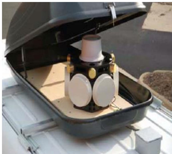
รูปที่ 7 กลุ่มสายอากาศถูกจัดเป็นกลุ่มและทำมุมแตกต่างกัน
