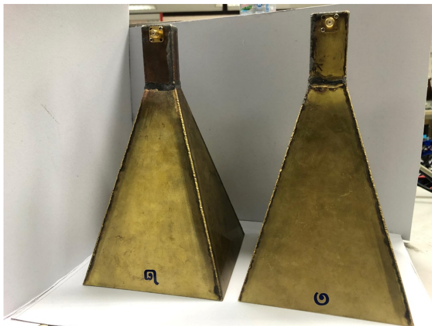
รูปที่ 5.11 สายอากาศปากแตรต้นแบบที่ออกแบบและสร้างขึ้น
