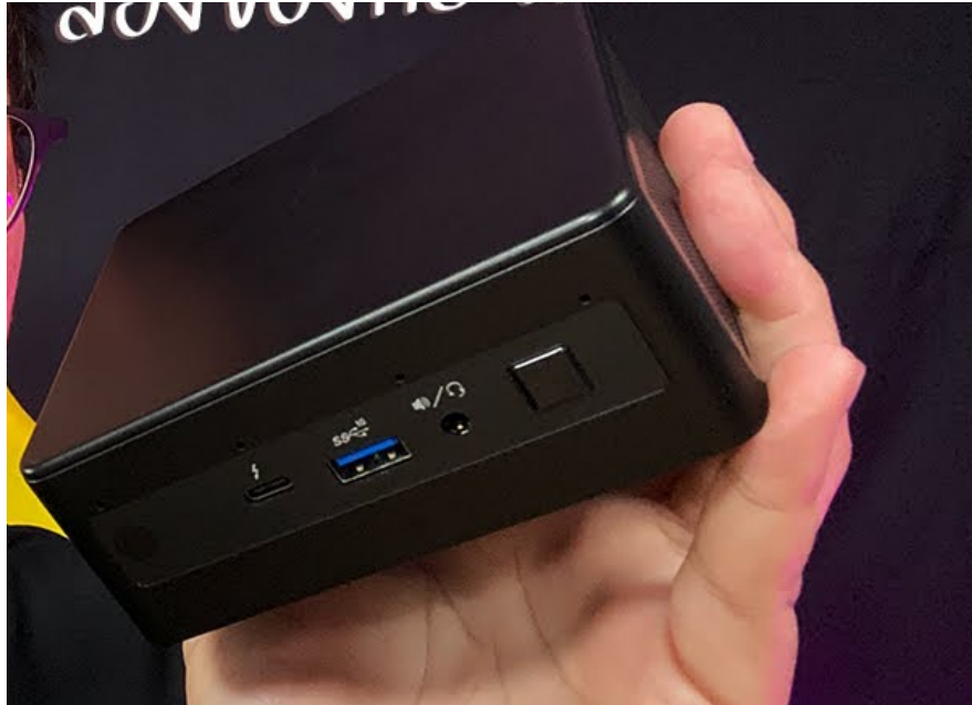
รูปที่ 8.3 (ก) ภาพรวมระบบควบคุมการทำงานของชุดหมุนสองแกน (ข) คอมพิวเตอร์ขนาดเล็ก (Mini PC) (INTEL NUC MINI PC 11PAHI7 Intel Core i7)
