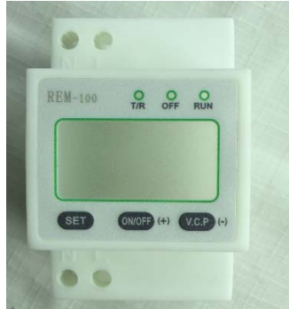
รูปที่ 16 รูปแบบ Housing เพื่อใช้บรรจุสมองกลและจอแสดงผล แบบสุดท้าย
