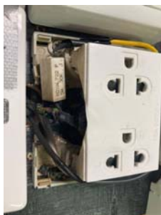
รูปที่ 26 การไหม้ของเต้าเสียบในชุดต้นแบบ
