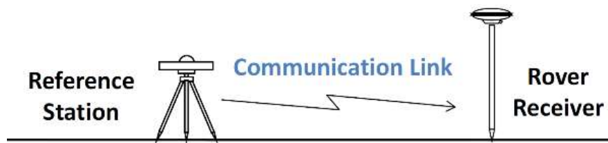
รูปที่ 2.13 การใช้งานระบบ RTK ในทางปฏิบัติ
