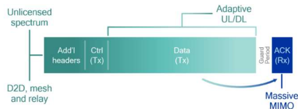
รูปที่ 4.11 การบรรจุเฟรมย่อยเองแบบรวม [25]
