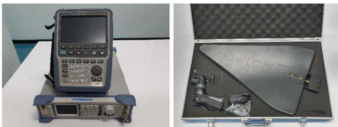
รูปที่ 3 ก) RF signal generator 8 kHz - 3 GHz และ Spectrum analyzer 5 kHz – 4 GHz ข) Aaronia active antenna 380 MHz – 8 GHz
