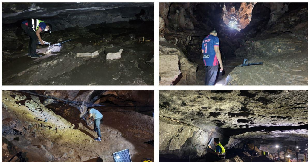
รูปที่ 127 การวัดทดสอบพฤติกรรมกรรมการแพร่คลื่นแบบคลื่นผิวโดยใช้ความถี่ย่าน LF, MF และ HF
