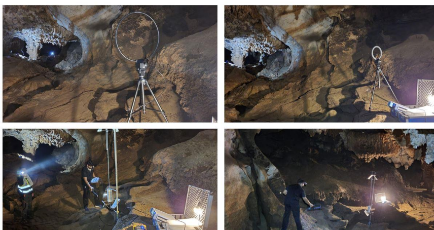
รูปที่ 11 แสดงภาพการติดตั้งอุปกรณ์และเครื่องมือสำหรับการวัดทดสอบแบบ LOS ย่านความถี่ LF, MF, HF และ VHF ภายในโพรงถ้ำเชียงดาว อ.เชียงดาว จ.เชียงใหม่
