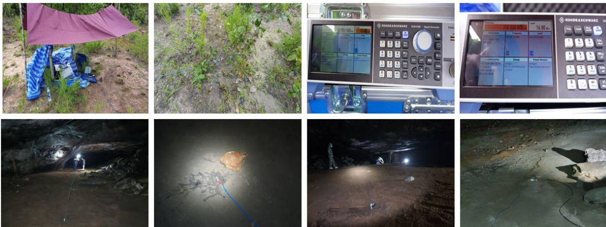
รูปที่ 139 การวัดทดสอบการแพร่คลื่นความถี่ 87 kHz และ 350 kHz ผ่านพื้นโลก (TTE) ที่ถ้ำปาฏิหาริย์
