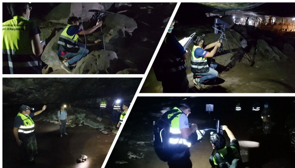
รูปที่ 66 การติดตั้งอุปกรณ์และเครื่องมือสำหรับการวัดทดสอบคลื่นความถี่ย่าน UHF แบบ LOS ภายในถ้ำปาฏิหาริย์
