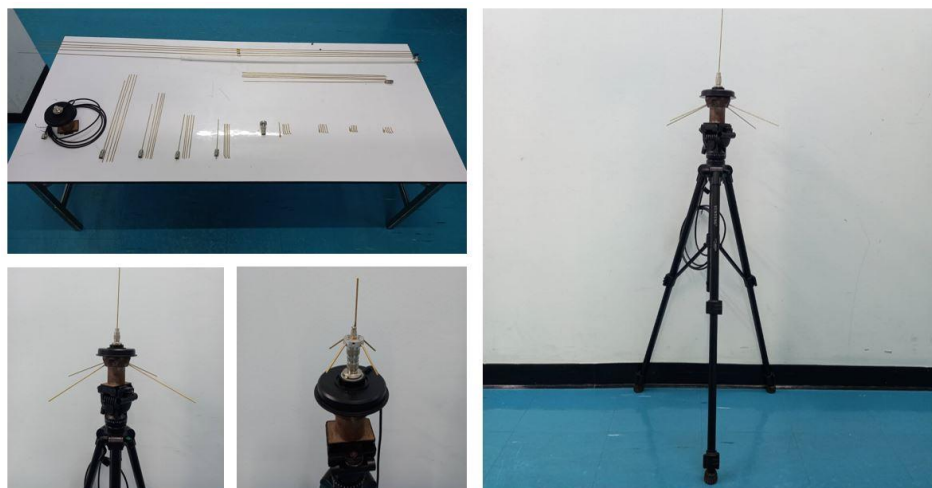
รูปที่ 4 สายอากาศควอเตอร์เวฟโมโนโพลกราวด์เพลน จำนวน 6 ชุดความถี่
