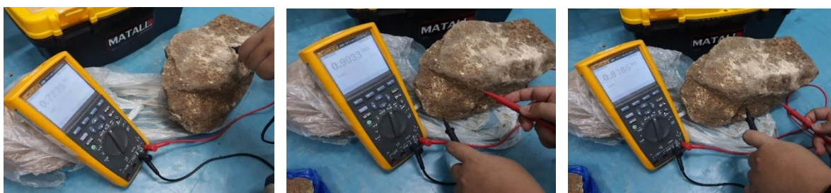
รูปที่ 9 การวัดค่าความต้านทานไฟฟ้า (Resistivity) ของตัวอย่างหินทรายที่เก็บจากภายในถ้ำปาฏิหาริย์ อ.โขงเจียม จ.อุบลราชธานี ในห้องปฏิบัติการ
