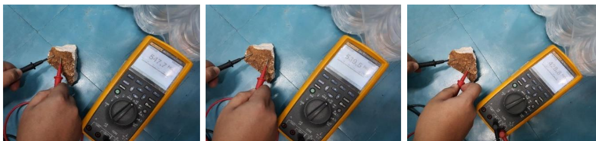
รูปที่ 10 การวัดค่าความต้านทานไฟฟ้า (Resistivity) ของตัวอย่างหินปูนที่เก็บจากภายในถ้ำเชียงดาว อ.เชียงดาว จ. เชียงใหม่ ในห้องปฏิบัติการ
