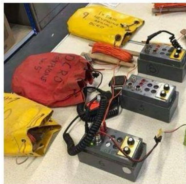
รูปที่ 2 ตัวอย่างเครื่องรับส่งวิทยุ HeyPhone สำหรับใช้ติดต่อสื่อสารในถ้ำย่านความถี่ LF (Low Frequency:) ภาพจาก http://www.shropshirecmc.org.uk/radio.html
