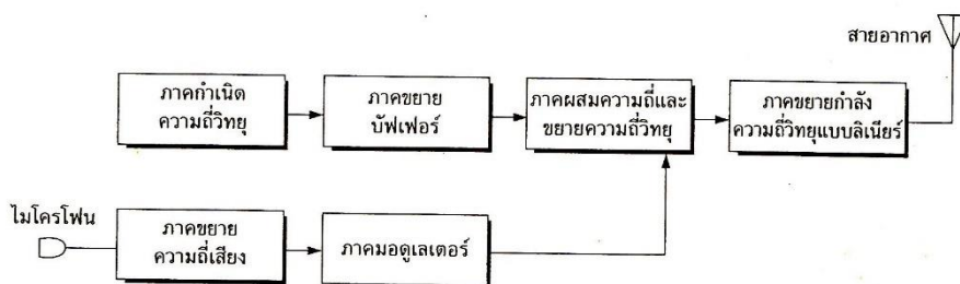
รูปที่ 6 แสดงไดอะแกรมเครื่องส่งวิทยุระบบ AM ที่ใช้การผสมสัญญาณระดับต่ำ [1]
