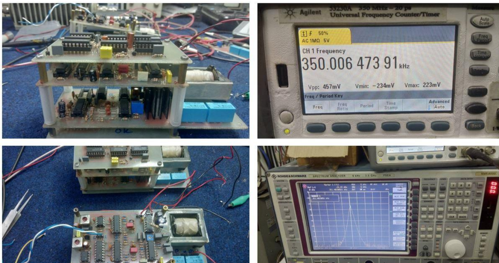
รูปที่ 34 ภาพแผ่น PCB ของวงจรอิเล็กทรอนิกส์ทั้งสามภาคที่ความถี่ 350 kHz ขณะวัดทดสอบในห้องปฏิบัติการวิจัย
