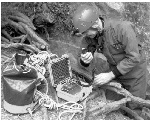
รูปที่ 12 ระบบวิทยุสื่อสารแบบแอนะล็อก HeyPhone สำหรับใช้งานในถ้ำ และการทดสอบใช้งานครั้งแรก
