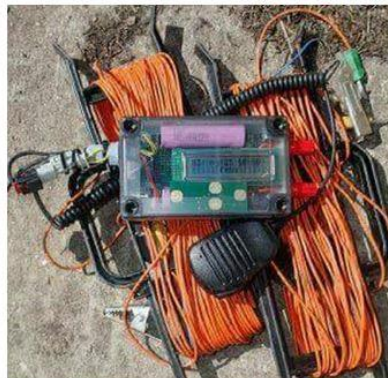
รูปที่ 2 ตัวอย่างเครื่องรับส่งวิทยุ HeyPhone สำหรับใช้ติดต่อสื่อสารในถ้ำย่านความถี่ LF (Low Frequency:) ภาพจาก http://www.shropshirecmc.org.uk/radio.html
