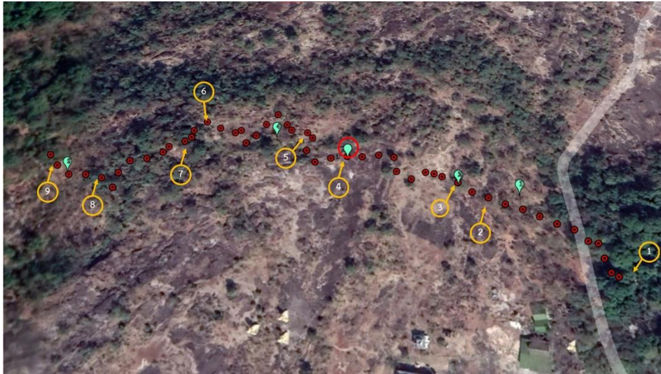
รูปที่ 40 แสดงตำแหน่งของสายอากาศภาครับ (วงกลมสีเหลือง) ที่ติดตั้งภายในทางเดินของโพรงถ้ำ และสายอากาศภาคส่ง (วงกลมสีแดง) ที่ติดตั้งบนภูเขาเหนือโพรงถ้ำปาฏิหาริย์
