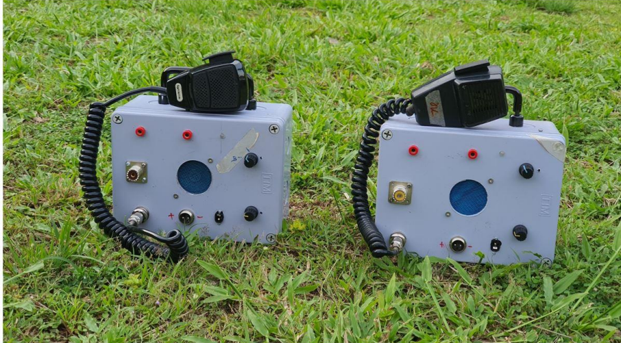
รูปที่ 38 ภาพเครื่องวิทยุสื่อสาร TTE-SSB-350 kHz ต้นแบบรุ่นแรก สำหรับทดสอบใช้งานครั้งแรกที่ถ้ำเชียงดาว จ.เชียงใหม่ (13 ตุลาคม 2564)
