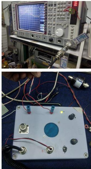
รูปที่ 35 แสดงการจัดเครื่องมือเพื่อวัดทดสอบกำลังส่งของเครื่องวิทยุสื่อสารต้นแบบ (ด้านซ้าย) และภาพแสดงค่ากำลังส่งในขณะที่ไม่มีการผสมสัญญาณใดๆ เข้าไป (ด้านขวา) ที่ความถี่ 350 kHz ขณะวัดทดสอบในห้องปฏิบัติการวิจัย
