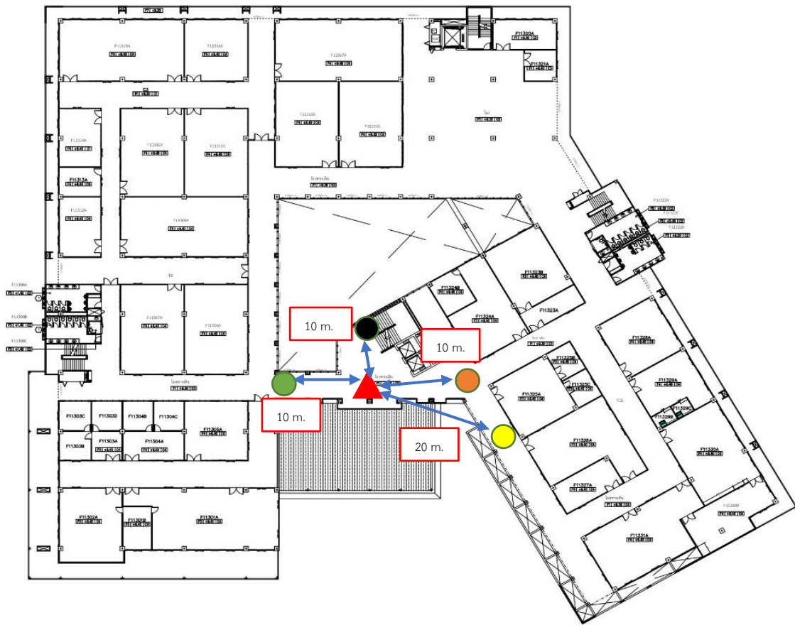
รูปที่ 72 แผนผังแสดงตำแหน่งการติดตั้งเราเตอร์และเครื่องมือสื่อสาร 4 เครื่อง ในระยะทางรูปแบบที่ 1 ตารางที่ 13 ผลการทดสอบการสื่อสารระหว่างเครื่องมือสื่อสาร 4 เครื่อง ในระยะทางรูปแบบที่ 1
