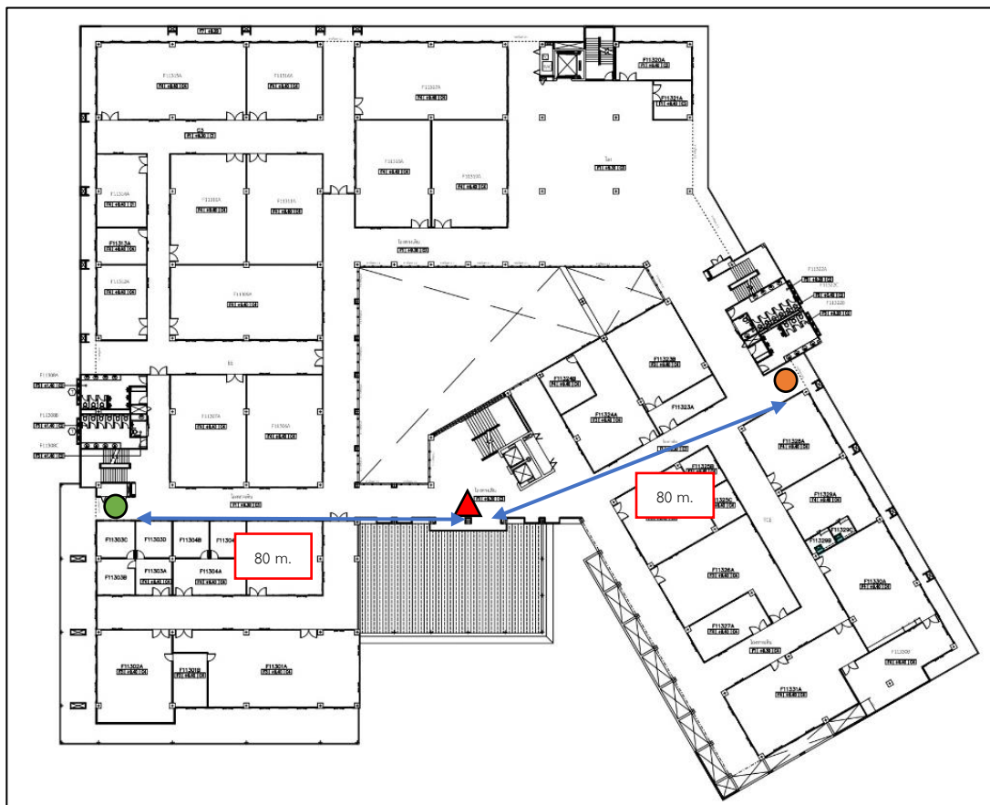
รูปที่ 68 แผนผังแสดงตำแหน่งการติดตั้งเราเตอร์และเครื่องมือสื่อสาร 2 เครื่องห่างกันเป็นระยะ 80 เมตร ตารางที่ 9 ผลการทดสอบการสื่อสารระหว่างเครื่องมือสื่อสาร 2 เครื่องที่ระยะห่าง 80 เมตร
