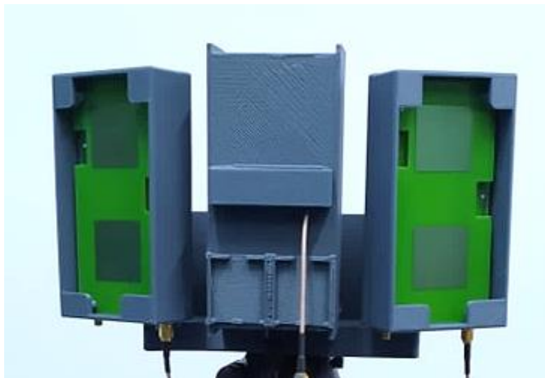
รูปที่ 127 อุปกรณ์ทวนสัญญาณที่พัฒนาโดยทีมวิจัย
