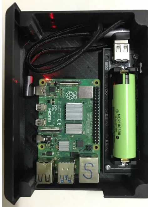
รูปที่ 80 อุปกรณ์เครื่องแม่ข่ายในระบบการสื่อสารทางเสียงผ่านโครงข่ายไร้สายแบบวีไอไอพี
