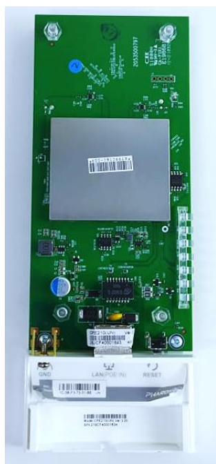
รูปที่ 121 แผ่วงจรพิมพ์การประมวลผลสัญญาณของสายอากาศ
