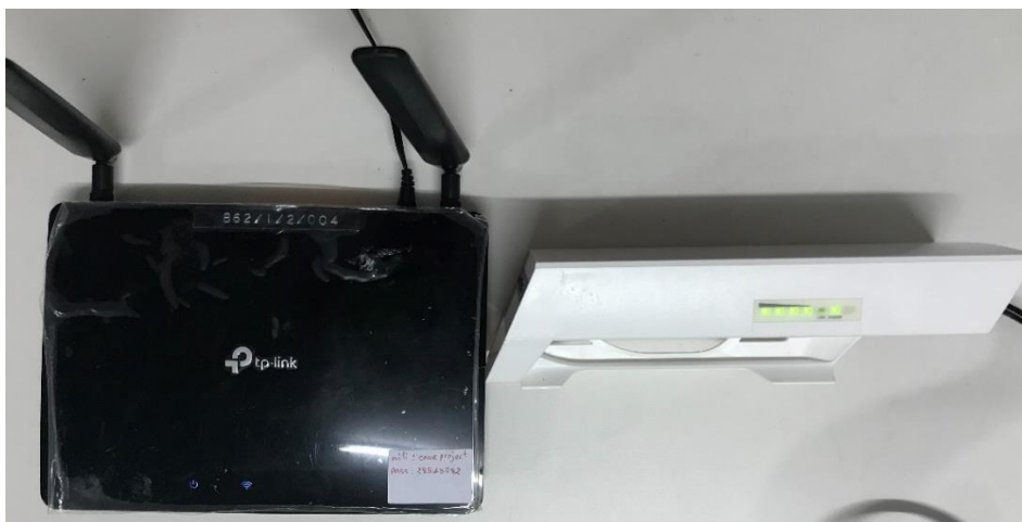
รูปที่ 93 เราเตอร์และอุปกรณ์ทวนสัญญาณจากเราเตอร์
