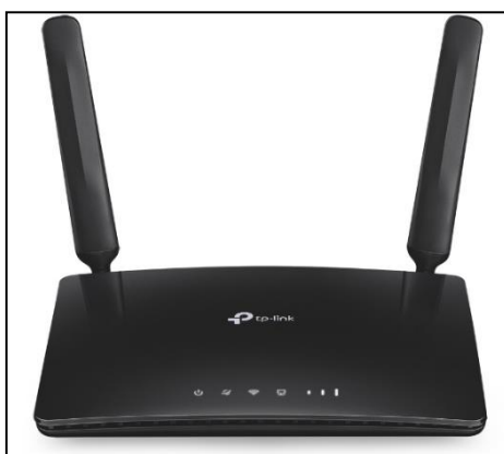
รูปที่ 11 อุปกรณ์ 4G Router Wireless AC750 Dual Band
