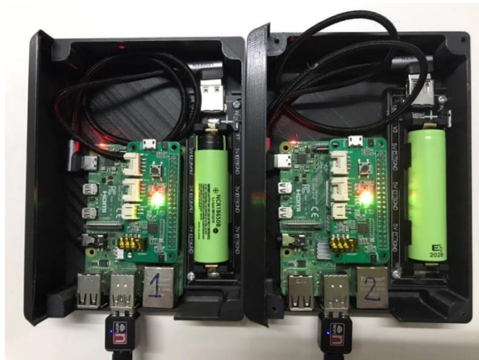
รูปที่ 90 แสงไฟแอลอีดีสีเขียวแสดงสถานะที่อุปกรณ์เครื่องลูกข่ายพร้อมใช้งานหรือในเครื่องแม่ข่าย มีอุปกรณ์เครื่องลูกข่ายอื่น ๆ ที่พร้อมใช้งานมากกว่า 1 อุปกรณ์
