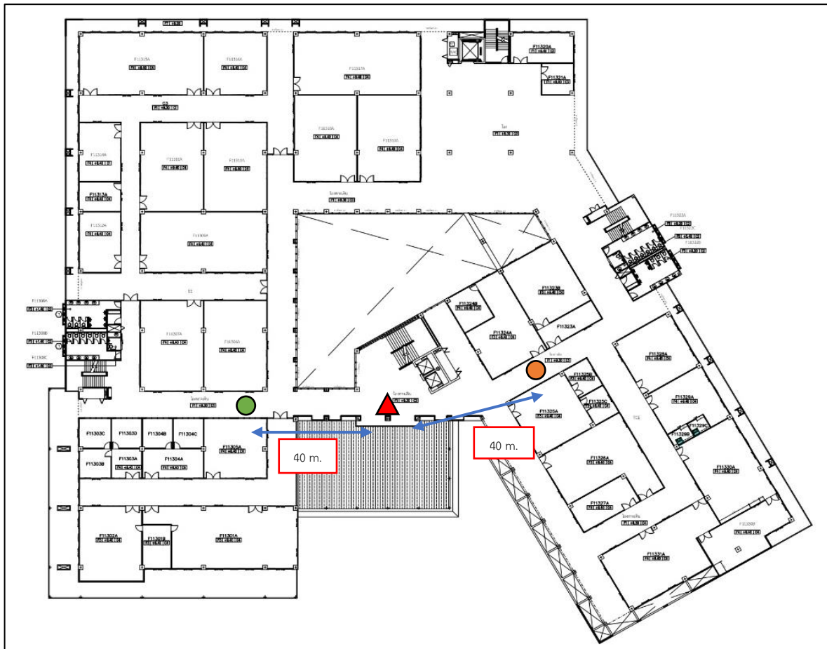
รูปที่ 67 แผนผังแสดงตำแหน่งการติดตั้งเราเตอร์และเครื่องมือสื่อสาร 2 เครื่องห่างกันเป็นระยะ 40 เมตร
