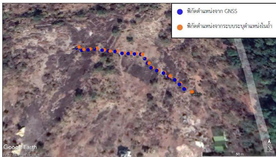
รูปที่ 105 แสดงผลการระบุตำแหน่งพิกัดของระบบระบุตำแหน่งในถ้ำเปรียบเทียบกับระบบ GNSS บริเวณพื้นที่โล่งบนภูเขา
