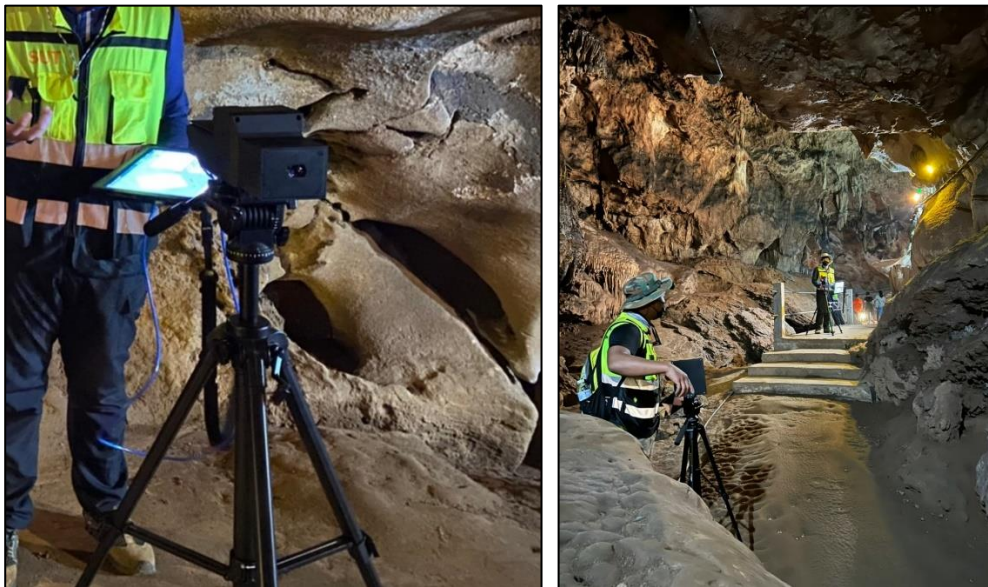
รูปที่ 110 แสดงการดำเนินการทดสอบระบบระบุตำแหน่งของถ้ำพระนอน
