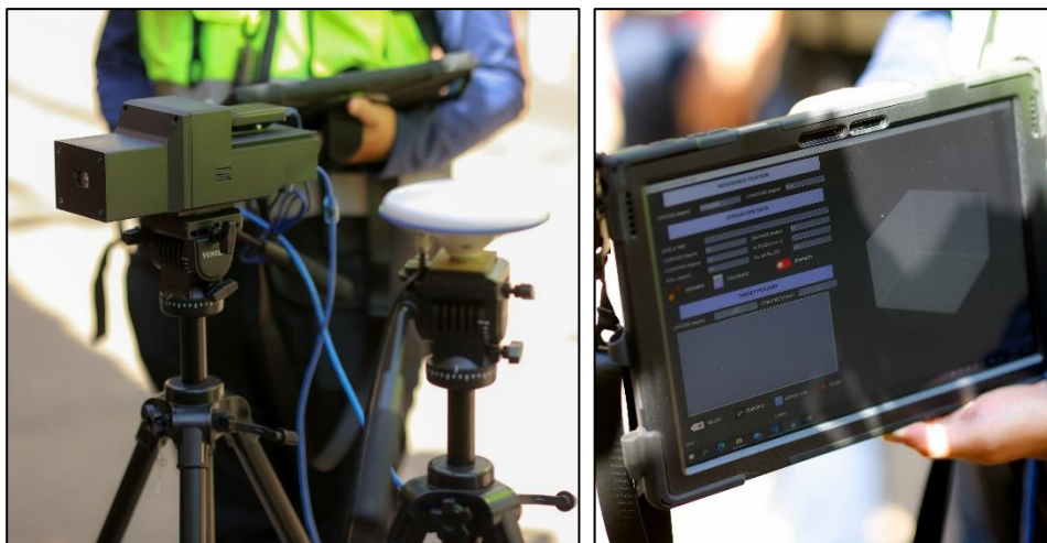
รูปที่ 108 แสดงการทดสอบระบบระบุตำแหน่งภายในถ้ำจากบริเวณจุดเริ่มต้นทางเข้าถ้ำหลวงเชียงดาว
