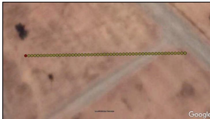
รูปที่ 22 แผนที่จากดาวเทียมแสดงตัวอย่างระยะห่างจุดละ 2 เมตร ทั้งหมด 50 จุด
