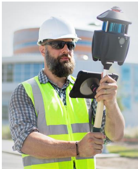
รูปที่ 10 การสแกน 3D ด้วยเครื่องสแกน LiDAR แบบมือถือรุ่น PX-80 จากบริษัท Paracosm [7]
