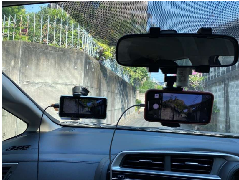
ภาพที่ 17-2 การติดตั้งอุปกรณ์เก็บข้อมูลของระบบฯ คู่กับอุปกรณ์ถ่ายวิดีโอซึ่งทำหน้าที่เป็นแหล่งความจริงสำหรับเทียบอ้างอิง
