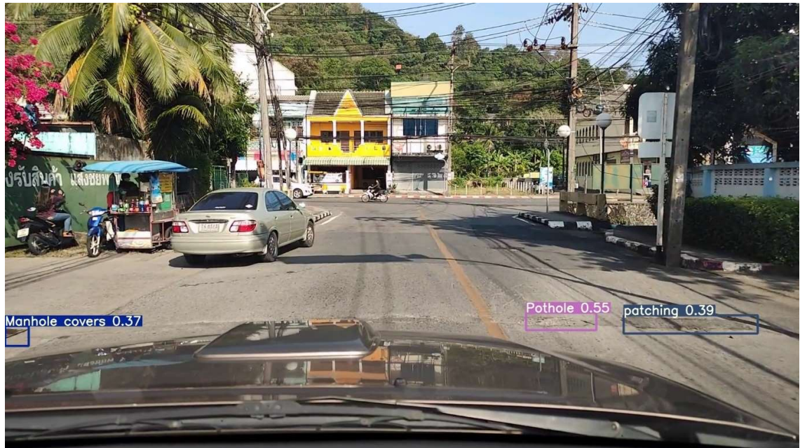
ภาพที่ 11-8 ผลจากการตรวจจับฝาท่อ (น้ำเงิน) หลุม (ชมพู) และรอยปะ (เขียว) บนถนนอย่างถูกต้อง
