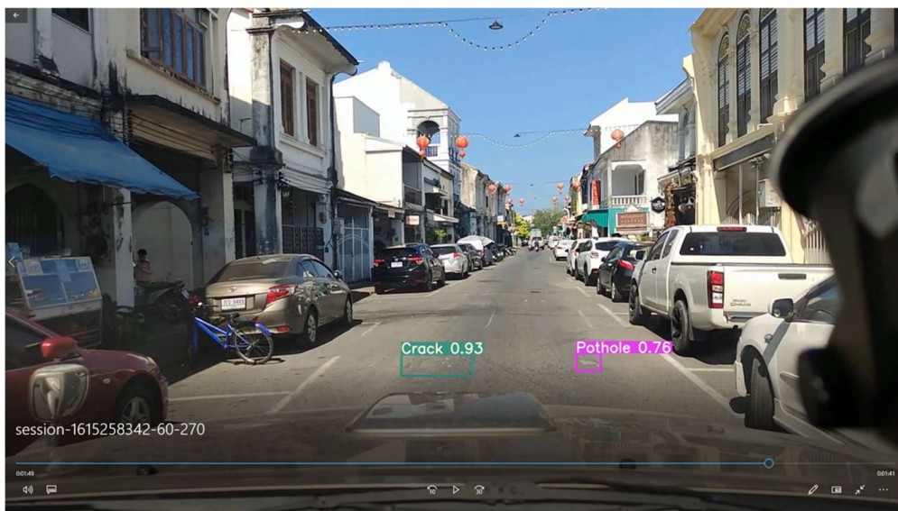
ภาพที่ 16-3 การทำงานของตัวจำแนก Machine Learning สำหรับการจำแนกประเภทความผิดปกติจากรูปภาพ (Object Detection Model)
