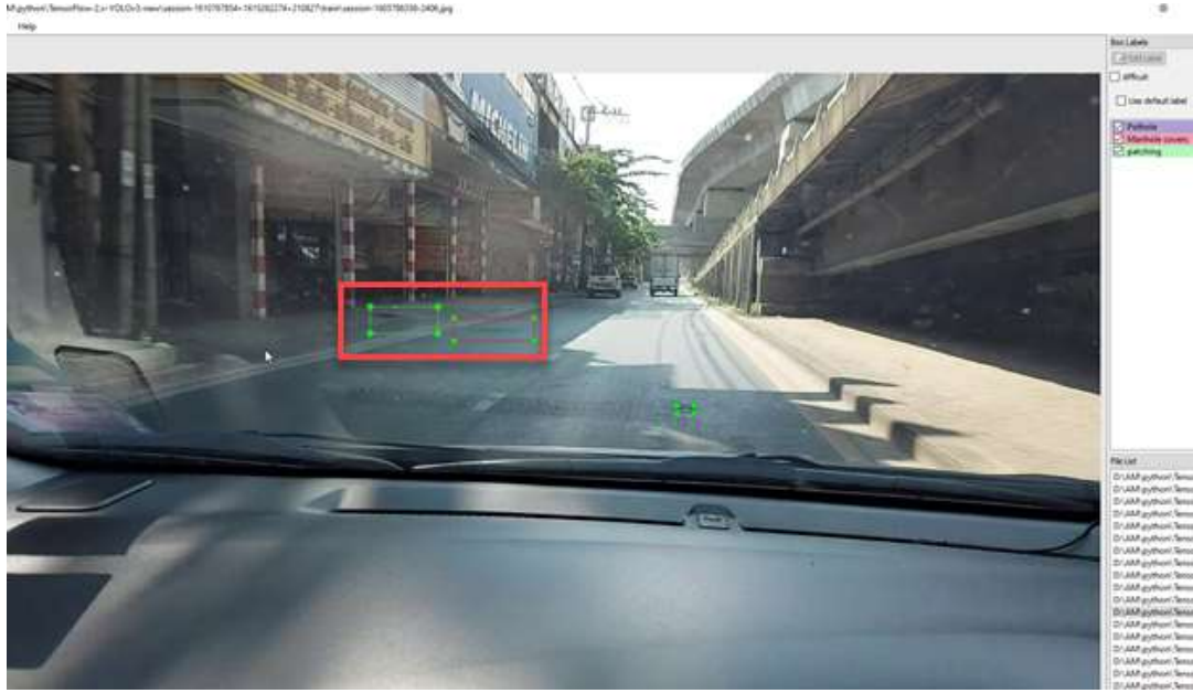
ภาพที่ 10-12 ในกรอบสีแดง วัตถุที่สนใจ อยู่ไกลเกินระยะที่กำหนด ซึ่งเป็นการ label ที่ไม่ถูกต้อง
