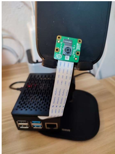
ภาพที่ 15-4 อุปกรณ์ต้นแบบที่ใช้ Raspberry Pi 4 Model B ในการพัฒนา
