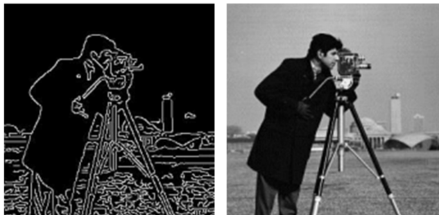
ภาพที่ 3-17 ตัวอย่างภาพต้นแบบและภาพที่ใช้วิธีการแคนนี่ [30]
