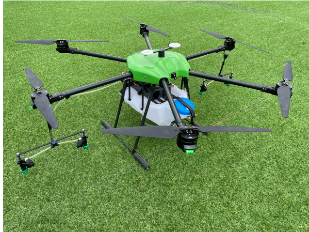
รูปที่ 10.4 โดรนการเกษตรใช้ในการทดสอบเรดาร์ตรวจจับโดรน
