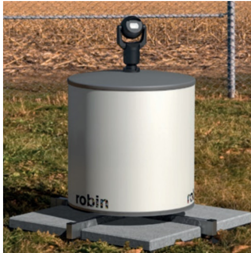
รูปที่ 2.4 ระบบเรดาร์ ELVIRA พร้อมติดตั้งกล้อง
