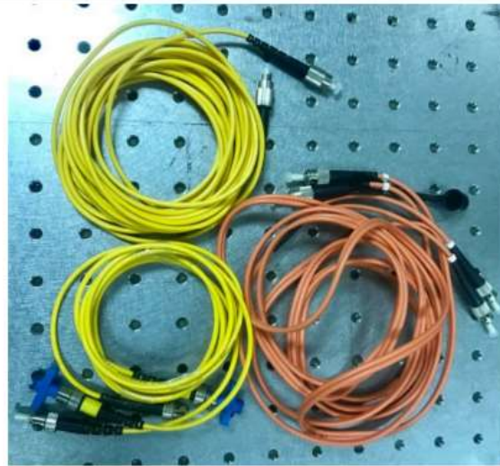
(ก) สายเคเบิลชนิดภายในอาคาร ชนิดโหมดเดี่ยว (สีเหลือง) และชนิดโหมดรวม (สีส้ม)
