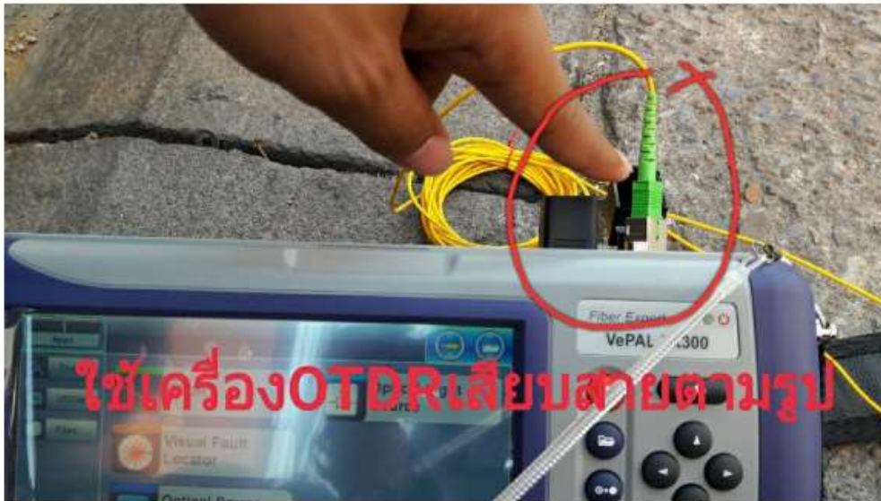
รูปที่ 4.2 เสียบหัว Connector เข้าเครื่อง OTDR
