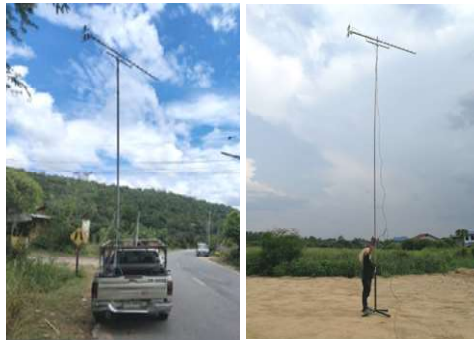
รูปที่ 2-11 ตัวอย่างรถยนต์ติดตั้งเสารับสัญญาณและลักษณะเสาสูง 8 เมตรพร้อมติดตั้งสายอากาศสำหรับวัดสัญญาณ
