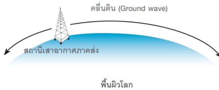
รูปที่ 4-8 แสดงการเดินทางของคลื่นที่เดินทางตามผิวโลก (Surface wave) หรือคลื่นดิน (Ground wave)
