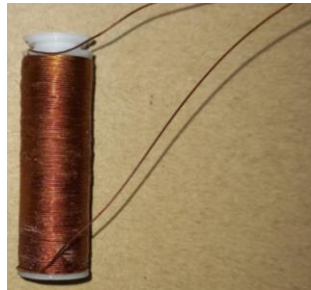
รูปที่ 36 ภาพถ่าย Coil Mount ที่ถูกพันด้วยขดลวด
