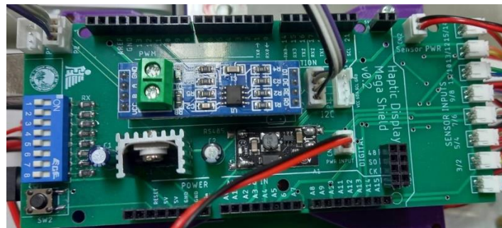
รูปที่ 61 ภาพถ่ายแผ่นวงจรไฟฟ้าสำหรับตัวควบคุมรองที่ได้ประกอบอุปกรณ์เป็นที่เรียบร้อยแล้ว
