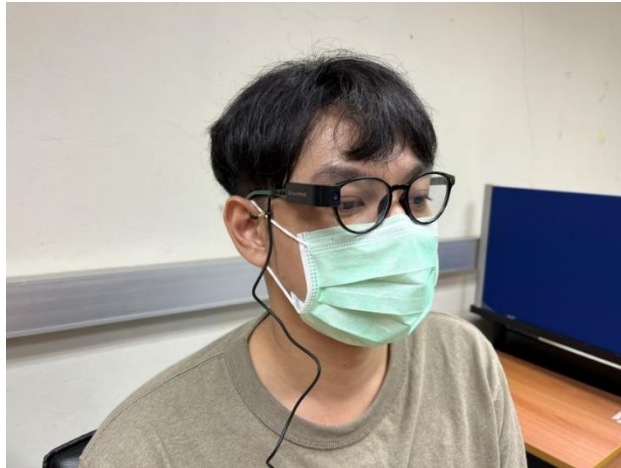
รูปที่ 94 กล้องรับภาพที่ยึดกับขาแว่นตา
