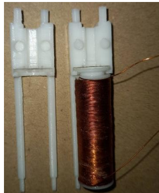
รูปที่ 37 ภาพถ่าย Coil Mount ที่ถูกพันด้วยขดลวดและประกอบเข้าไปใน Cell Top
