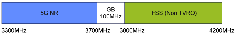
รูปที่ 82 รูปแบบการจัดสรรคลื่นความถี่ ในกรณีที่ไม่วิเคราะห์ให้บริการ TVRO ในคลื่น C-band
