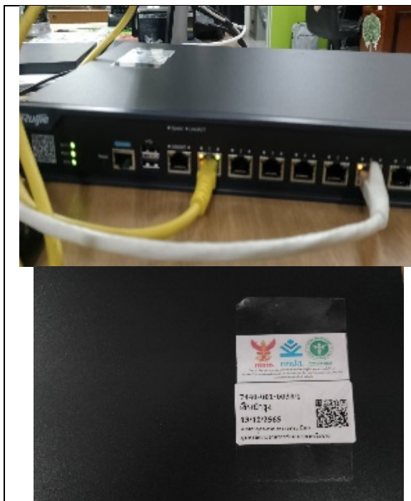
อุปกรณ์กระจายการทำงานสำหรับเครือข่าย (link load balancer)
