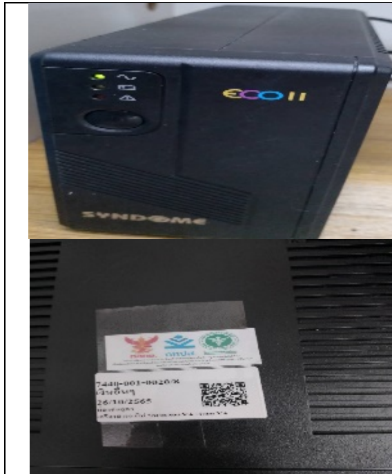
เครื่องสำรองไฟฟ้าขนาด 800 Va
