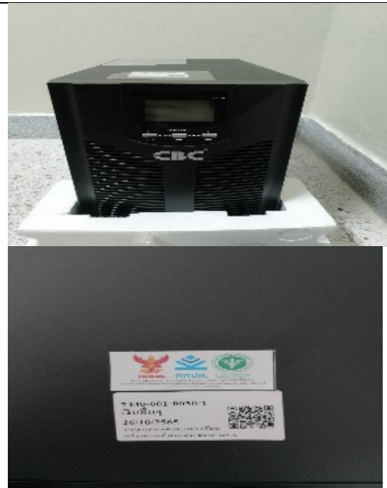
เครื่องสำรองไฟฟ้าขนาด 3 KVa
