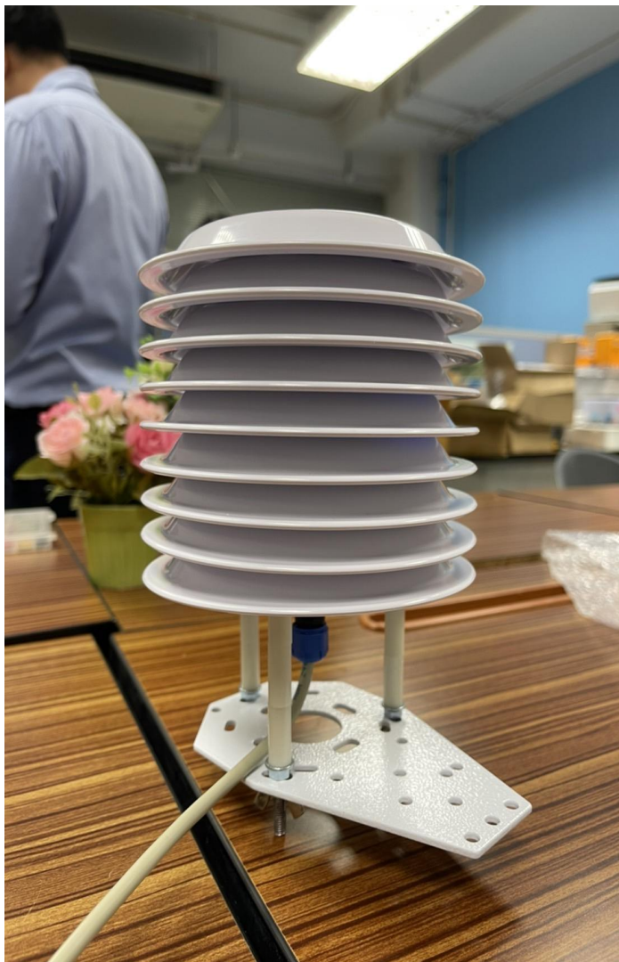
ภาพที่ 37 ชุดเซ็นเซอร์ที่ประกอบอยู่ใน Plates Radiation Shields ซึ่งทำจากวัสดุพลาสติก ABS
