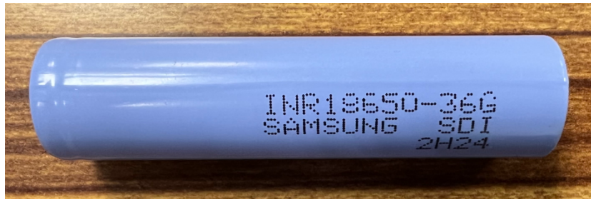
ภาพที่ 44 ภาพแบตเตอรี่แบบ 18650 แรงดันไฟที่ 3.7V
