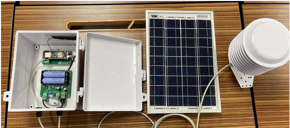
ภาพที่ 33 เครื่องวัดฝุ่นละอองขนาดเล็ก (PM2.5)
